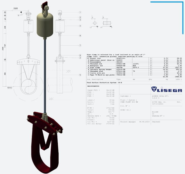
LICAD® offre aux utilisateurs un outil professionnel pour la conception, le développement, l'implantation et les plans de supports de tuyauteries – de sorte que ces travaux se font plus rapidement avec souplesse et efficacité.
