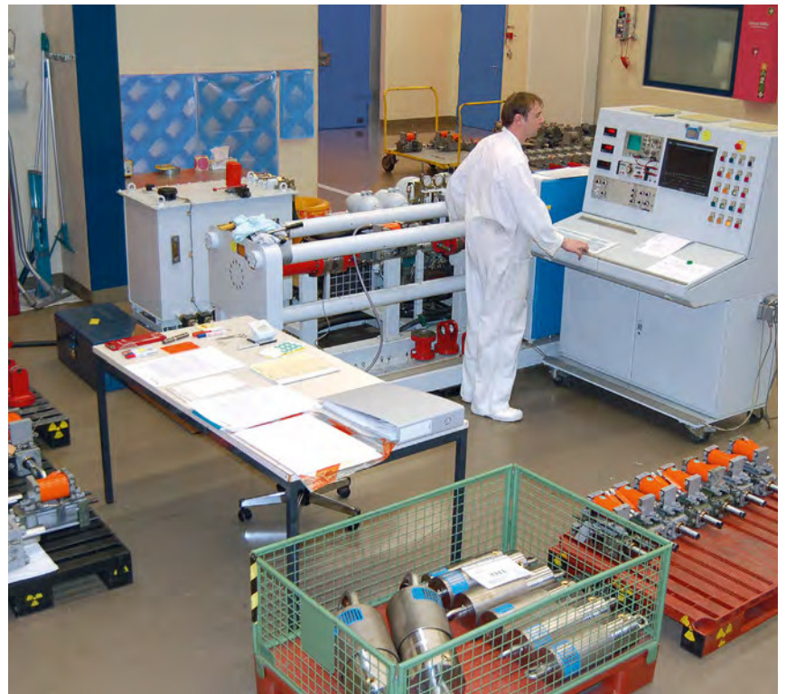
現地での可搬式試験装置による他メーカー製スナバーの試験
