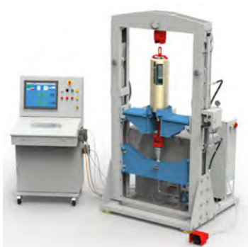
LISEGA 120kN 試験装置でのスプリングハンガーの試験
