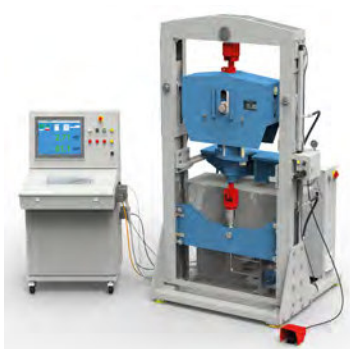
LISEGA 120kN 試験装置でのコンスタントハンガーの試験
