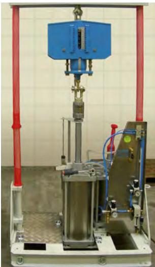
可搬式試験装置による現地でのコンスタントハンガーの性能試験
