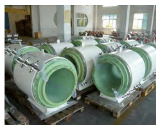
仮組み立てされた断熱サポート
