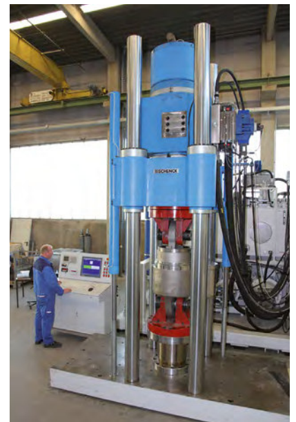
2500kN 試験装置 (LISEGA工場)
