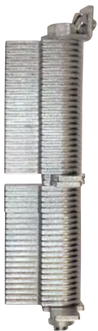
スプリングハンガー・サポート タイプ 21, 25, 29, 20 のロック装置は、どの位置にでも固定できる鋼製の薄板で構成されています。3枚までスプリングハンガーに挿入できます。
