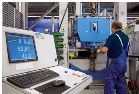
コンスタントハンガーの承認試験
