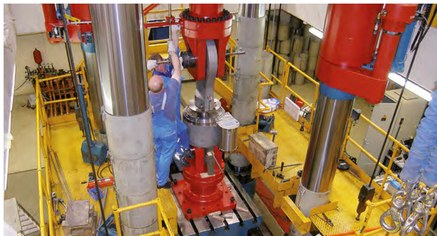
スナバー タイプ 31の試験 試験荷重=最大8600kN
