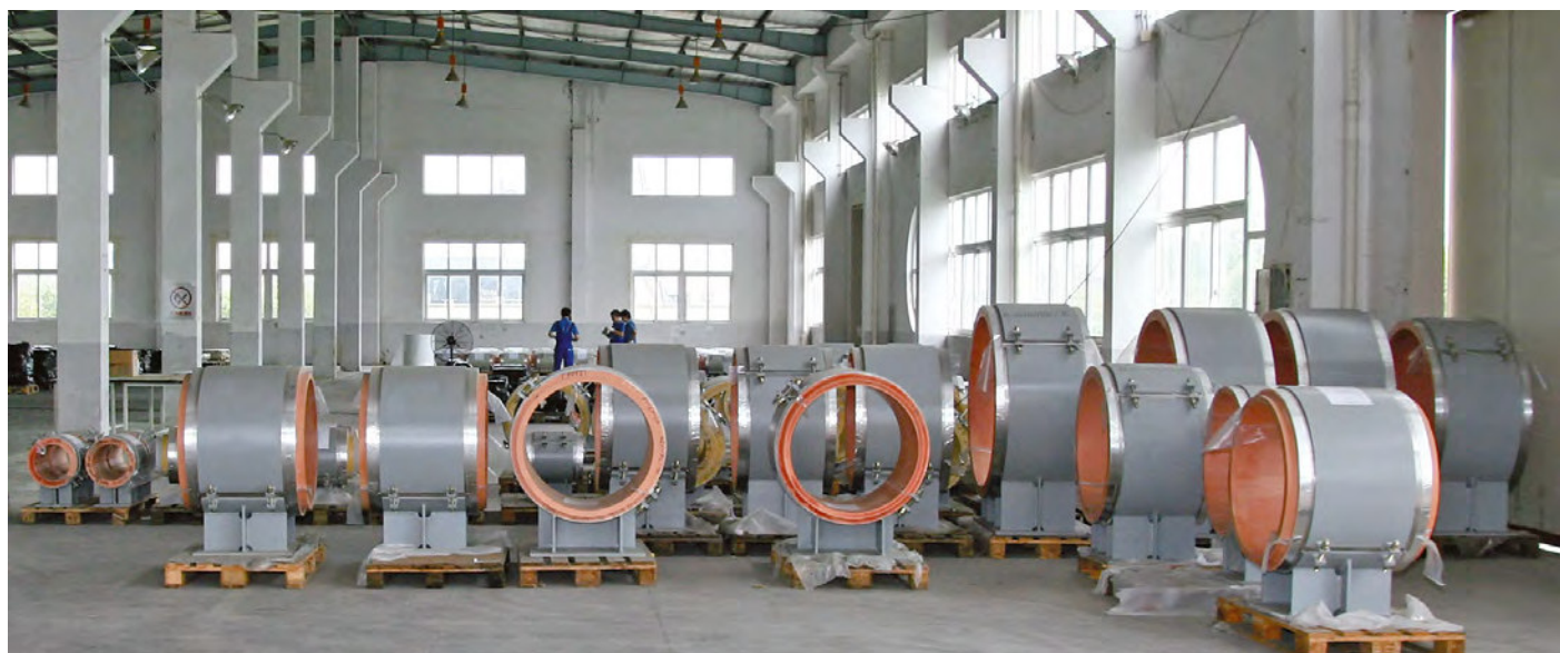
仮組み立てされた断熱サポート
