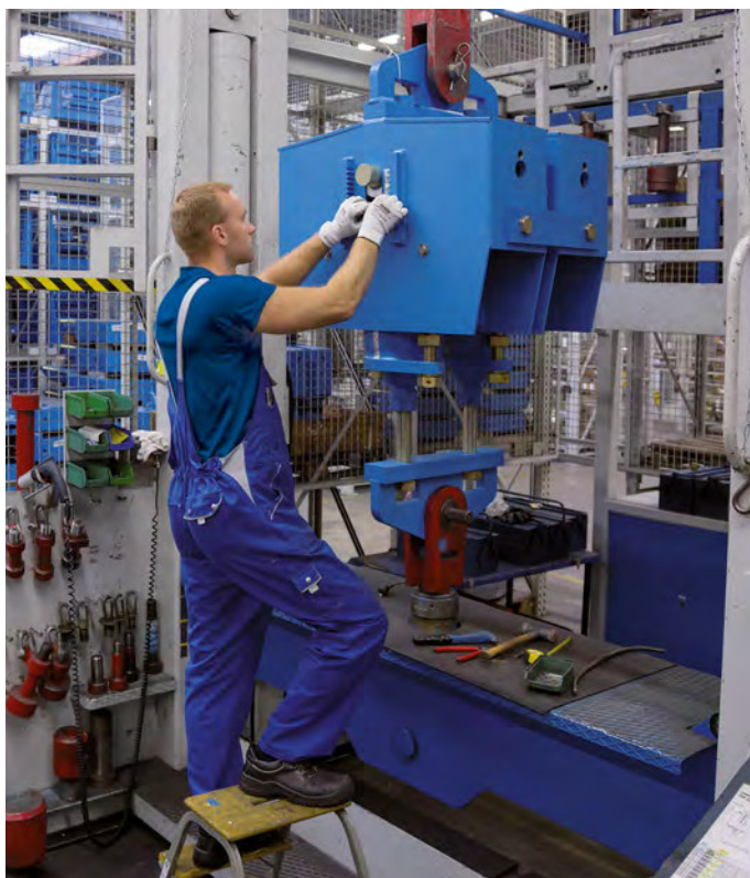
500kN 試験装置を使用した、コンスタントハンガー タイプ12 の荷重設定、試験及びロック装置取付
