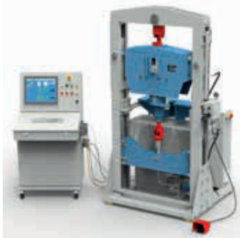
Испытание подвески постоянного усилия на испытательном стенде LISEGA на 120 кН
