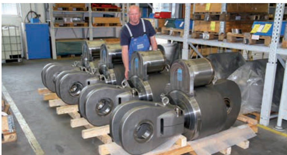
Окончательная проверка ударных стопоров типа 31
