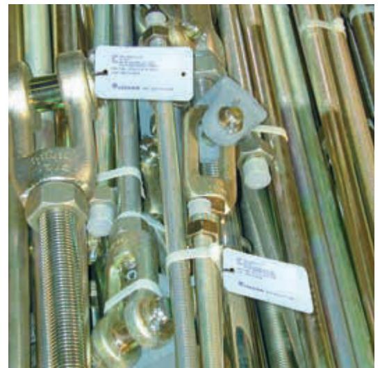
Нагрузочные цепи, предварительно собранные, сгруппированные и маркированные
