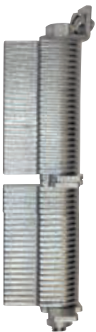
Блокирующее устройство для пружинных подвесок и пружинных опор типов 21, 25, 29 и 20 состоит из набора металлических пластин, которые могут быть повернуты в любое требуемое положение блокировки. В пружинные подвески может вставляться до 3-х блокирующих устройств.
