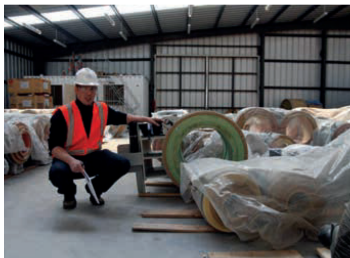
Окончательная проверка низкотемпературных изолированных опор
