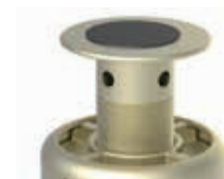
Тип 29 с плитой, воспринимающей нагрузку, и скользкими подложками из PTFE (ПТФЭ)
