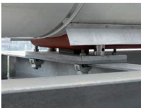
Хомутовая опора типа 49 на скользящей подложке с присоединением к металлоконструкции с помощью балочных адаптеров
