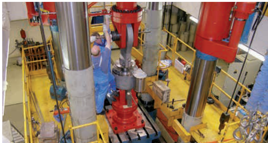
Проведение специальных испытаний ударных стопоров типа 31. Испытательная нагрузка до 8600 кН
