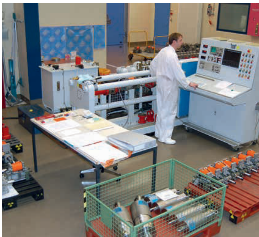
Испытание ударных стопоров различных марок на электростанции с помощью мобильного испытательного стенда LISEGA.
