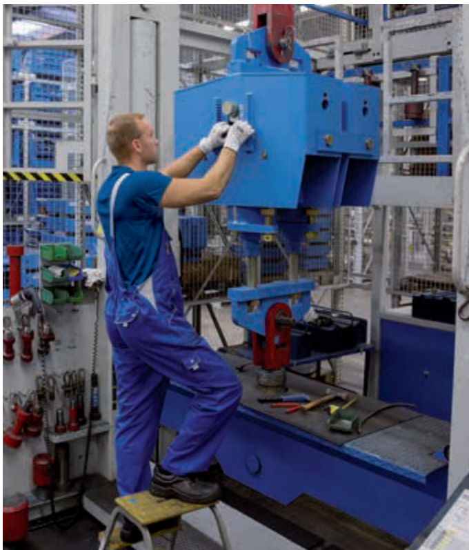
Калибровка, испытание и блокировка подвески постоянного усилия типа 12 на испытательном стенде 500кН
