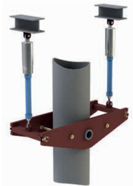
Защита вертикального участка трубопровода с помощью ударных стопоров типа 30 с монтажными удлинителями типа 33 и динамическим трубным хомутом типа 34
