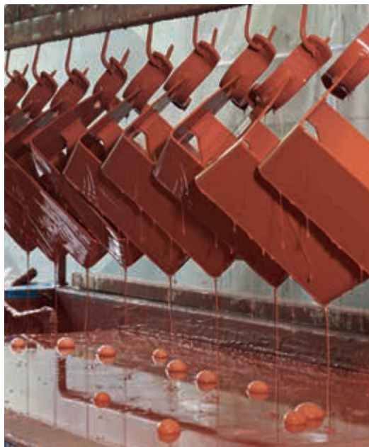
катафорезное грунтование погружением
