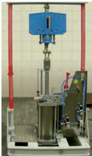
Испытание подвесок постоянного усилия на месте эксплуатации с помощью мобильного испытательного стенда
