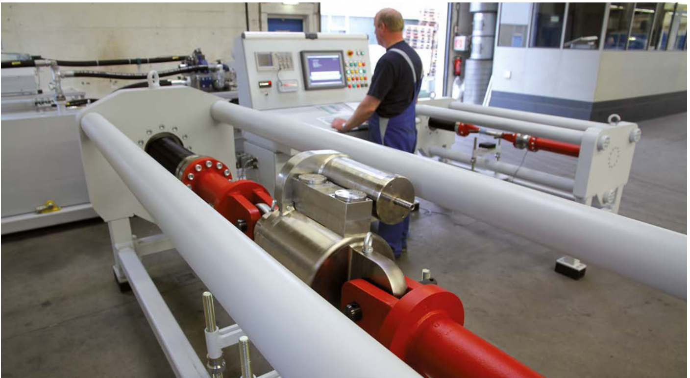
Banco de pruebas para amortiguadores hidráulicos
