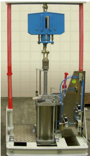
Pruebas en soportes colgantes de carga constante en un banco de pruebas móvil desplazado hasta un emplazamiento
