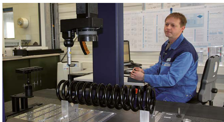
Pruebas en resortes durante la recepción del material
