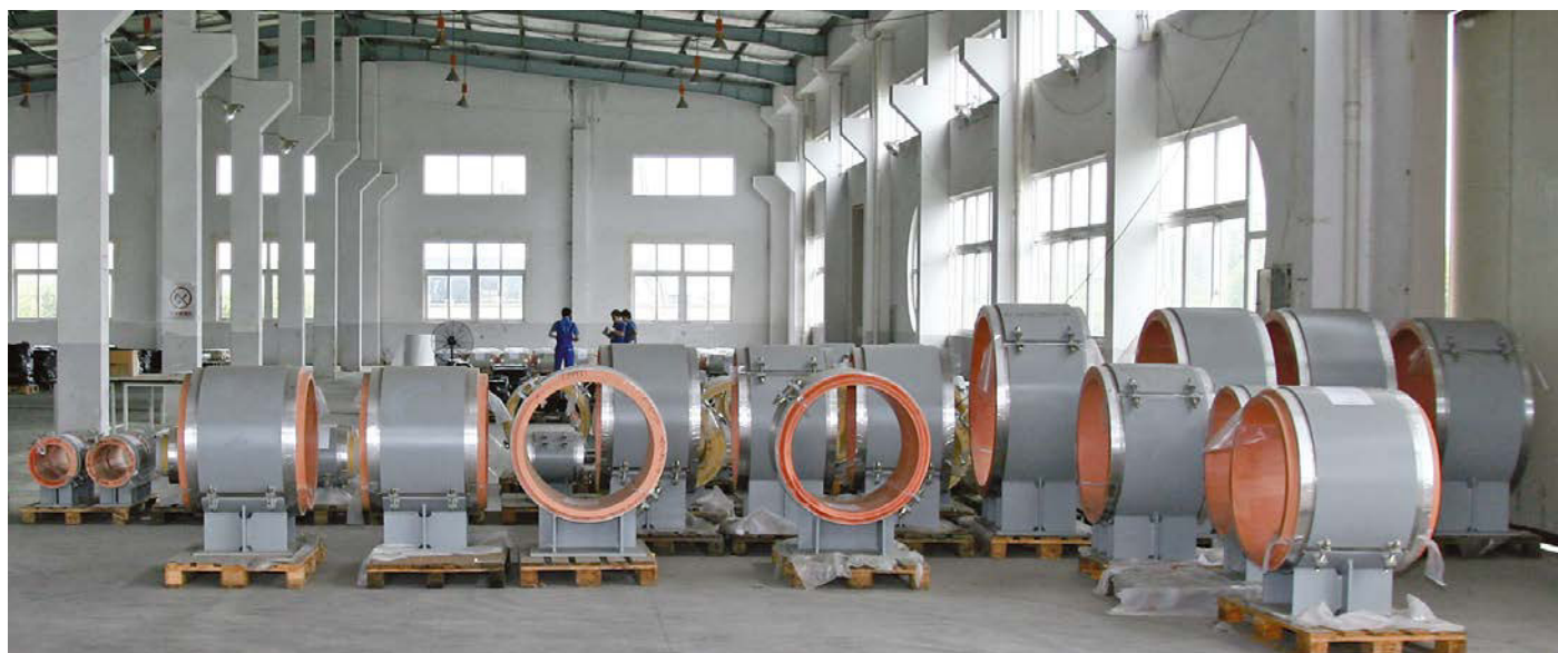
Soportes para tuberías con aislamiento premontados
