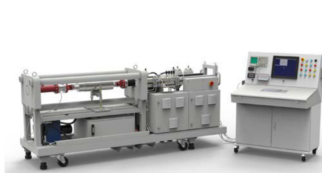
Banco de pruebas móvil para amortiguadores hidráulicos PR50 de 50 kN de LISEGA
