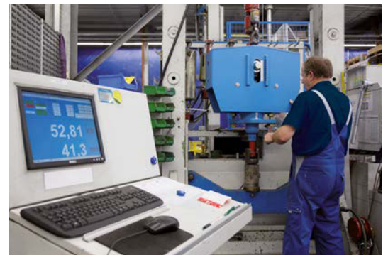
Pruebas de aceptación de un soporte colgante de carga constante
