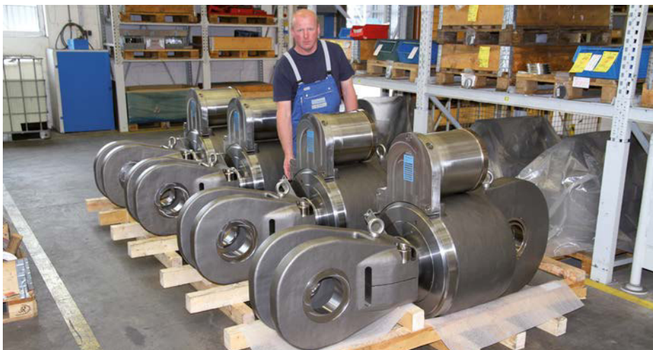
Inspección final de amortiguadores hidráulicos tipo 31
