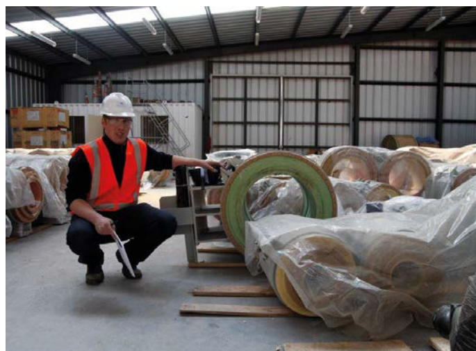
Inspección final de patines con abrazadera criogénicos
