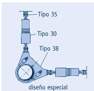
Diagrama funcional, amortiguador hidráulico tipo 30
