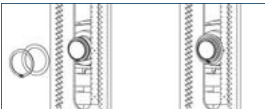
② Montage des äußeren Sicherungsringes ③ Fertig: deblockierter Zustand
