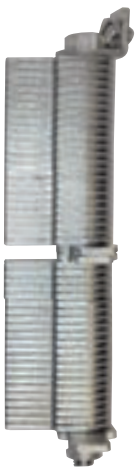
Die Blockierung besteht bei Federhängern und Federstützen der Typen 21, 25, 29 und 20 aus Blechlamellen, die auf jede gewünschte Lasteinstellung einstellbar sind. Es werden bis zu 3 Blockierungen an einem Federhänger eingesetzt.
