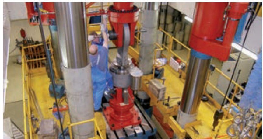
Sonderprüfung von Stoßbremsen Typ 31 Prüflast bis 8600KN
