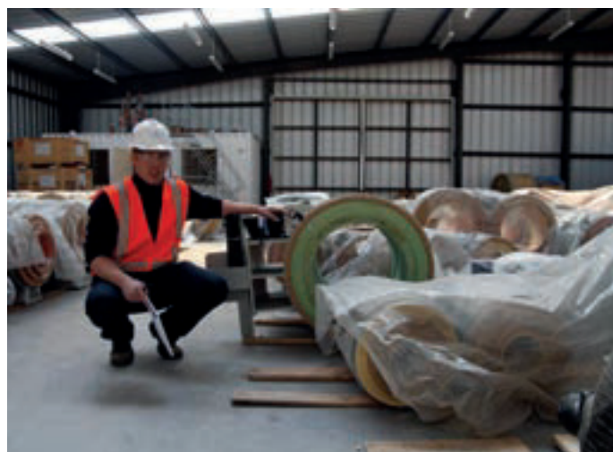
Endkontrolle von kälteisolierten Rohrlagern
