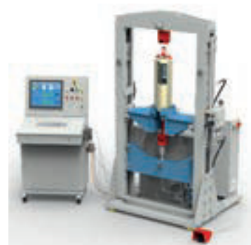
Prüfen eines Federhängers am LISEGA-120kN-Prüfstand
