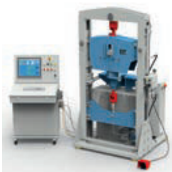
Prüfen eines Konstanthängers am LISEGA-120kN-Prüfstand
