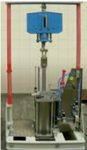
Prüfen von Konstanthängern vor Ort mit einem mobilen Prüfstand
