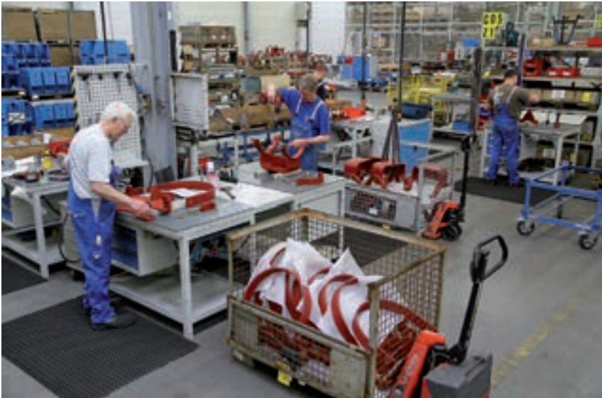
Vormontage von Lastketten
