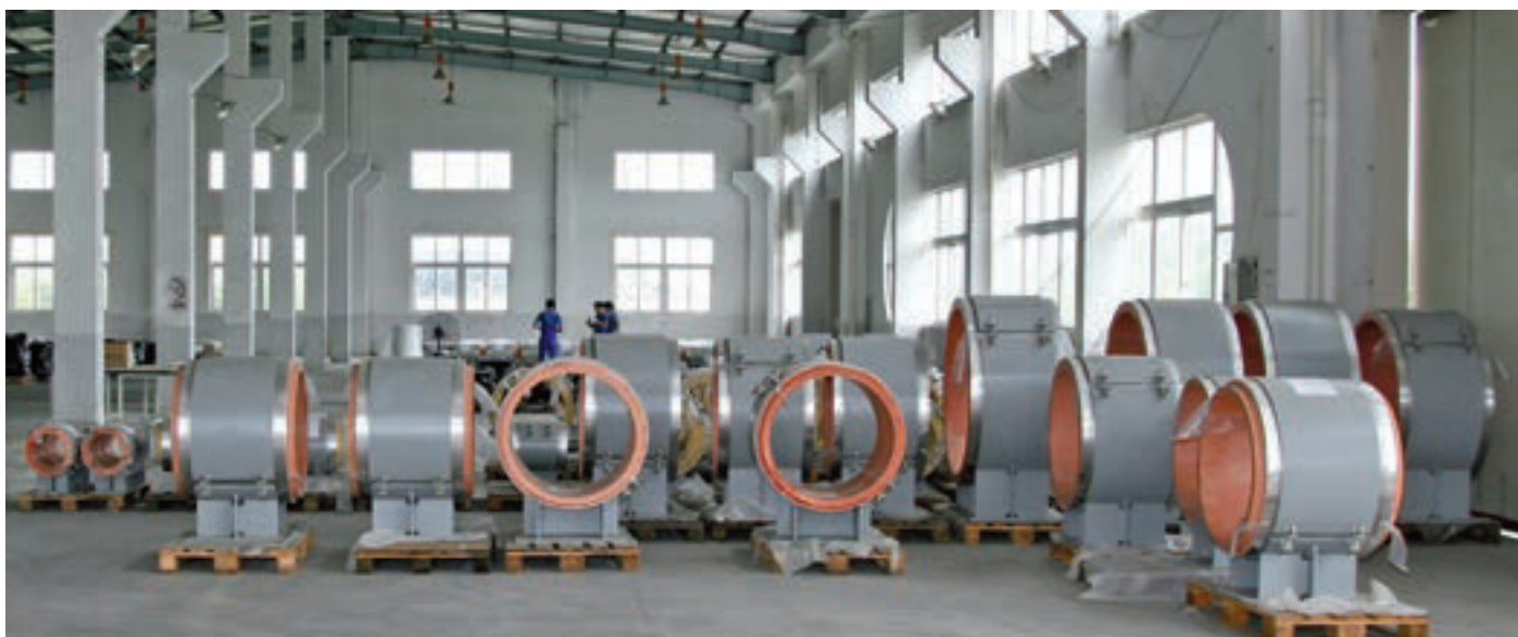
Vormontierte kälteisolierte Rohrlager
