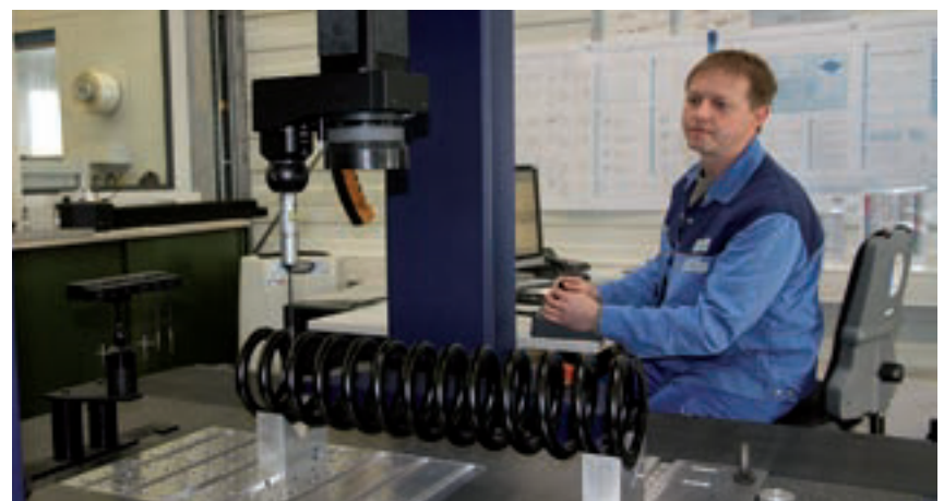
Wareneingangsprüfung der Federn
