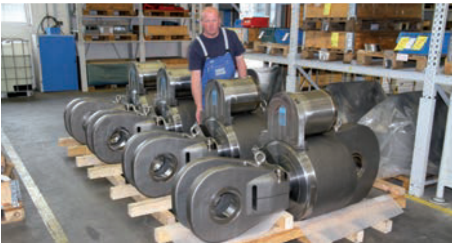
Endkontrolle von Stoßbremsen Typ 31
