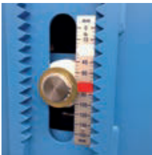
Wegskala mit Kalt- / Warmmarkierungen
