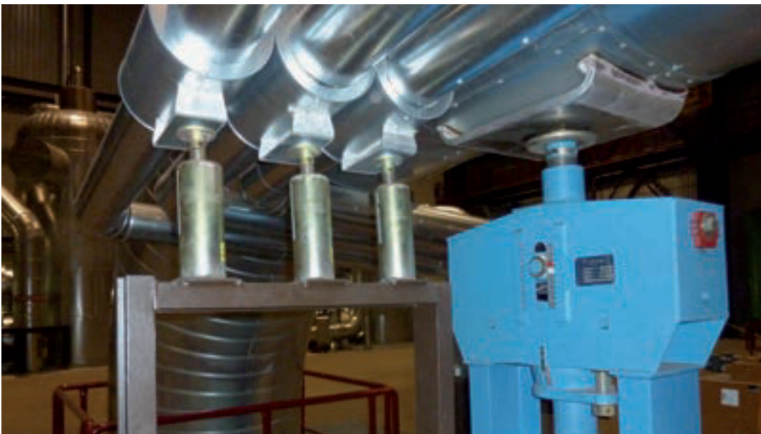
Typische Anwendung von Gleitelementen unter Rohrlagern
