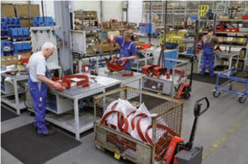
Pré-montage des chaînes de support
