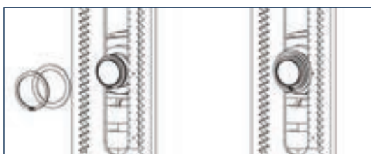
② Remise en place du circlip extérieur
