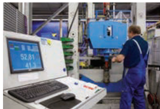
Essai de réception d'un Support Constant
