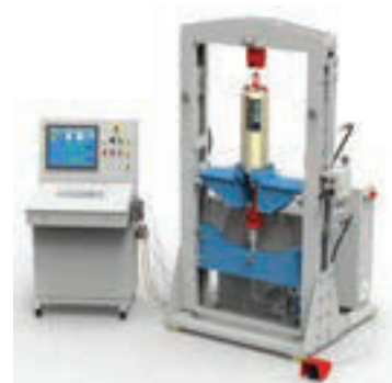
Essai d'un Support Variable sur banc LISEGA de 120kN
