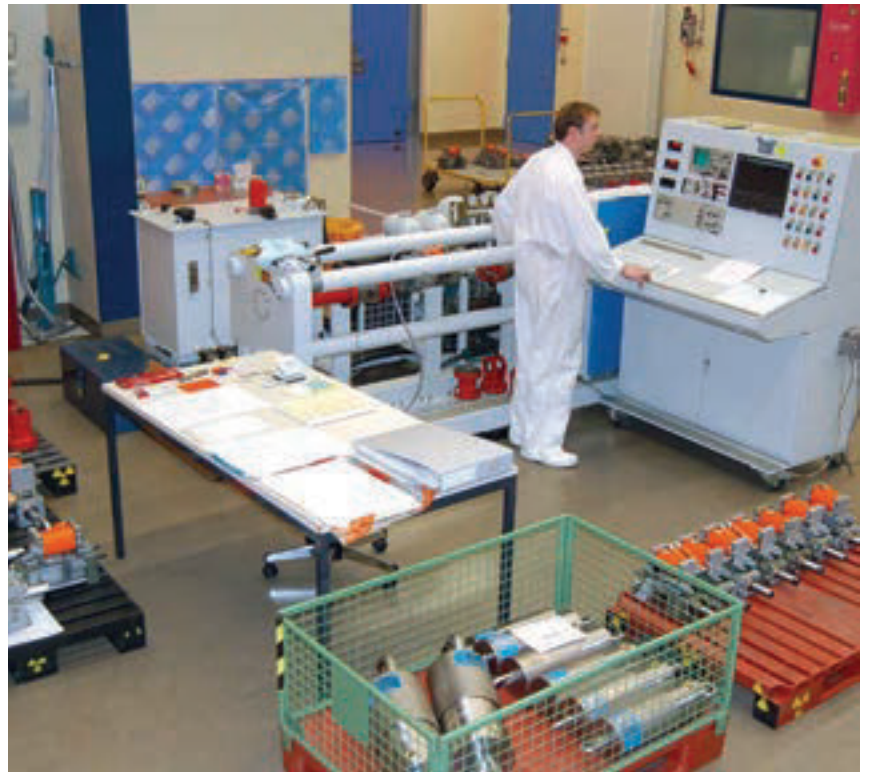
Contrôle de DAB des différents fournisseurs sur site avec un BANC D'ESSAI LISEGA transportable
