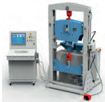
Prueba de un soporte colgante de carga constante en un banco de pruebas de 120 kN de LISEGA
