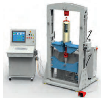
Prueba de un soporte colgante de carga variable en un banco de pruebas de 120 kN de LISEGA
