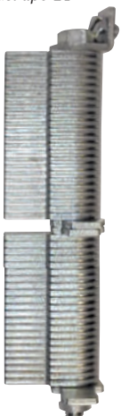
El dispositivo de bloqueo de los soportes colgantes de carga variable y los soportes de carga variable tipos 21, 25, 29 y 20 consiste de lamelas de chapa metálica ajustables a cualquier posición de carga deseada. En un soporte colgante de carga variable pueden insertarse hasta tres dispositivos de bloqueo.
