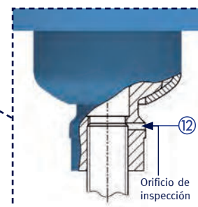
Profundidad de ajuste de rosca mínima de la varilla de conexión en un tubo de carga.
