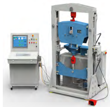
LISEGA 120kN 試験装置での コンスタントハンガーの試験
