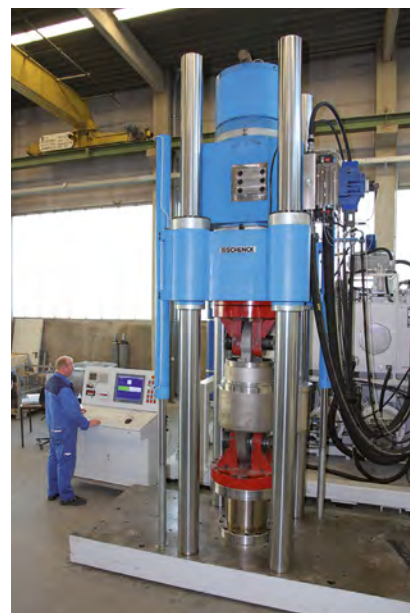
2500kN 試験装置 (LISEGA工場)
