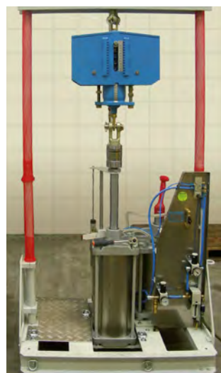
可搬式試験装置による現地での コンスタントハンガーの性能試験
