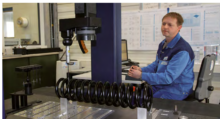
材料受入時のばねの試験
