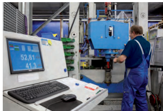
コンスタントハンガーの承認試験
