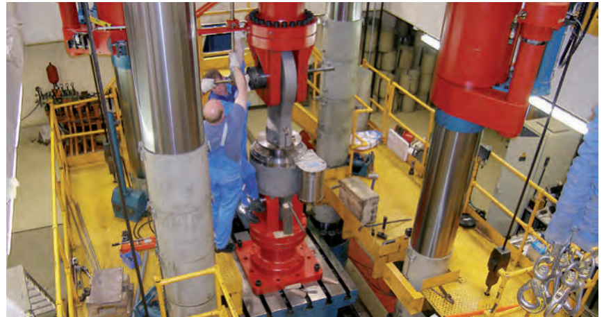
スナバー タイプ 31の試験 試験荷重=最大8600kN
