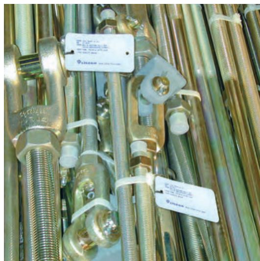
仮組み立てして梱包、マーキングされたハンガー部品
