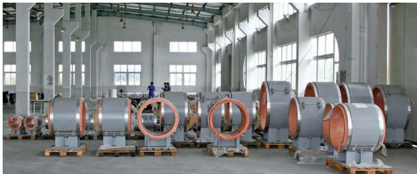
仮組み立てされた断熱サポート
