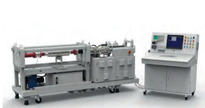
可搬式 LISEGA 50kN スナバー試験装置PR50
