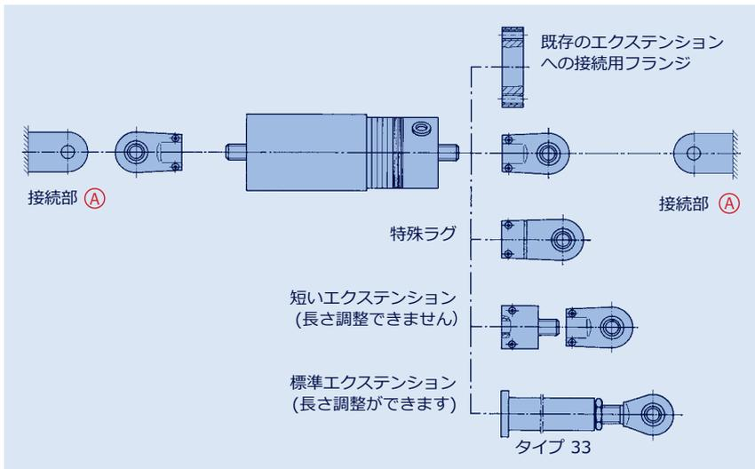
Ⓐ 接続可能な部品：溶接ブラケットタイプ 35、または製品グループ 3のダイナミッククランプのピン径参照
