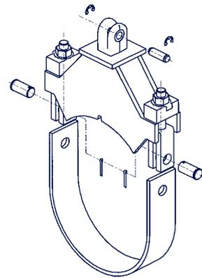
クランプの位置をチェックしてから、ボルトをしっかり締めたあと、舌付き座金でナットの廻り止め処置をします。
