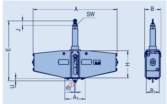
配管システムの大きな水平移動に対応して、コンスタントサポートに球面軸受付きのジョイントが取付けできます。
