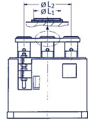
スライドプレートを使用する場合は、相手方製品のスライド面にステンレス鋼のプレートを取付けてください。これはタイプ番号の後ろに「SP」の記号をつけて指示します。(例：クランプベース タイプ 49 97 14-SP)。
