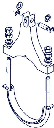
取付け前に、仮組みされたUボルトを外します。上部部分をシアラグにあわせて置てください。Uボルトと当板を反対側から挿入し、最初は軽く締めてください。クランプの位置をチェックしてから、ボルトを締めて廻り止めしてください。
