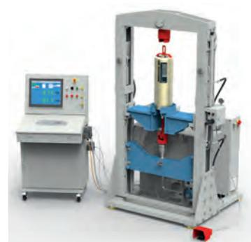
LISEGA 120kN 試験装置でのスプリングハンガーの試験
