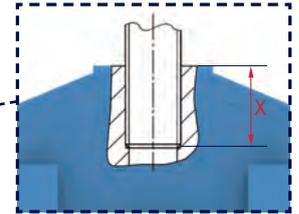
上側接続部の最小ねじ込み深さX (タイプ 11の選定表1.15ページ参照)
