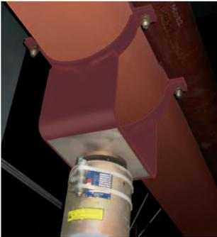
LISEGAスライドプレートは大きな荷重で水平方向に移動するところにも使用されます。スライドプレートを使用することにより、移動に必要な力は最大60%まで低減できます。スライドプレートの使用は配管システム全体の配置に好ましい効果があります。
