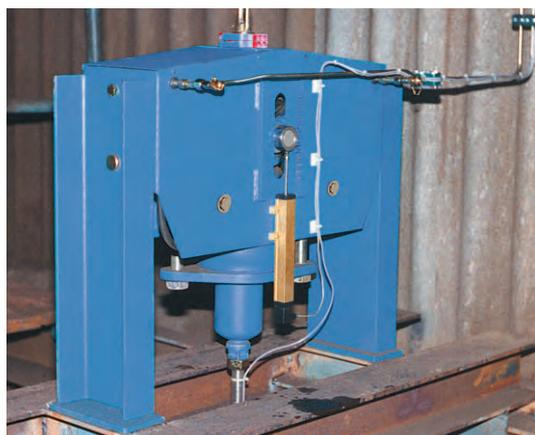
標準的には、支持する配管システムの温度を制御パラメーターとして使用します。この温度は対応するトラベル位置へ電子的に変換されます。理論値と実測値の比較によって実際のレベル位置に対して移動を制御します。
