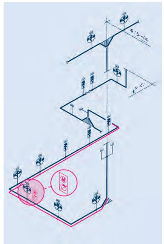
油圧サーボのサポートを使用することにより、配管システムは所定のレベルに再設定されます。
