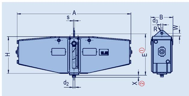
① 取付け寸法Eは上限位置での長さです。他のセット位置ではE寸法が長くなります。
