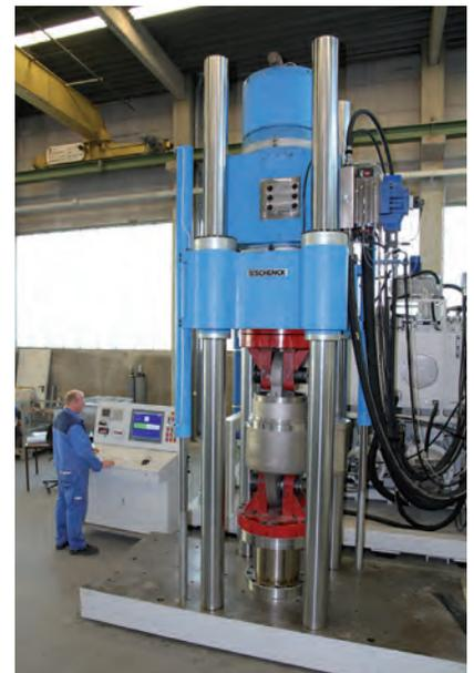
2500kN 試験装置 (LISEGA工場)
