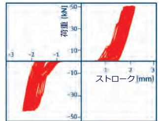
定格荷重を超える交番荷重による荷重-トラベルの軌跡計測
