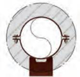
特別仕様の腐食防止では、350℃を超える配管の接続部品のねじ部品、ボルト、ストラップ、プレート、Uボルトは、据付指示に従って保温の中に納まるようにしてください。
