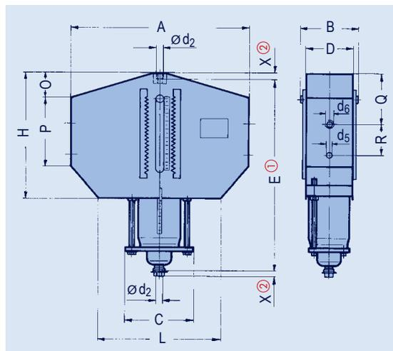
① 取付け寸法Eは上限位置での長さです。他のセット位置ではE寸法が長くなります。
