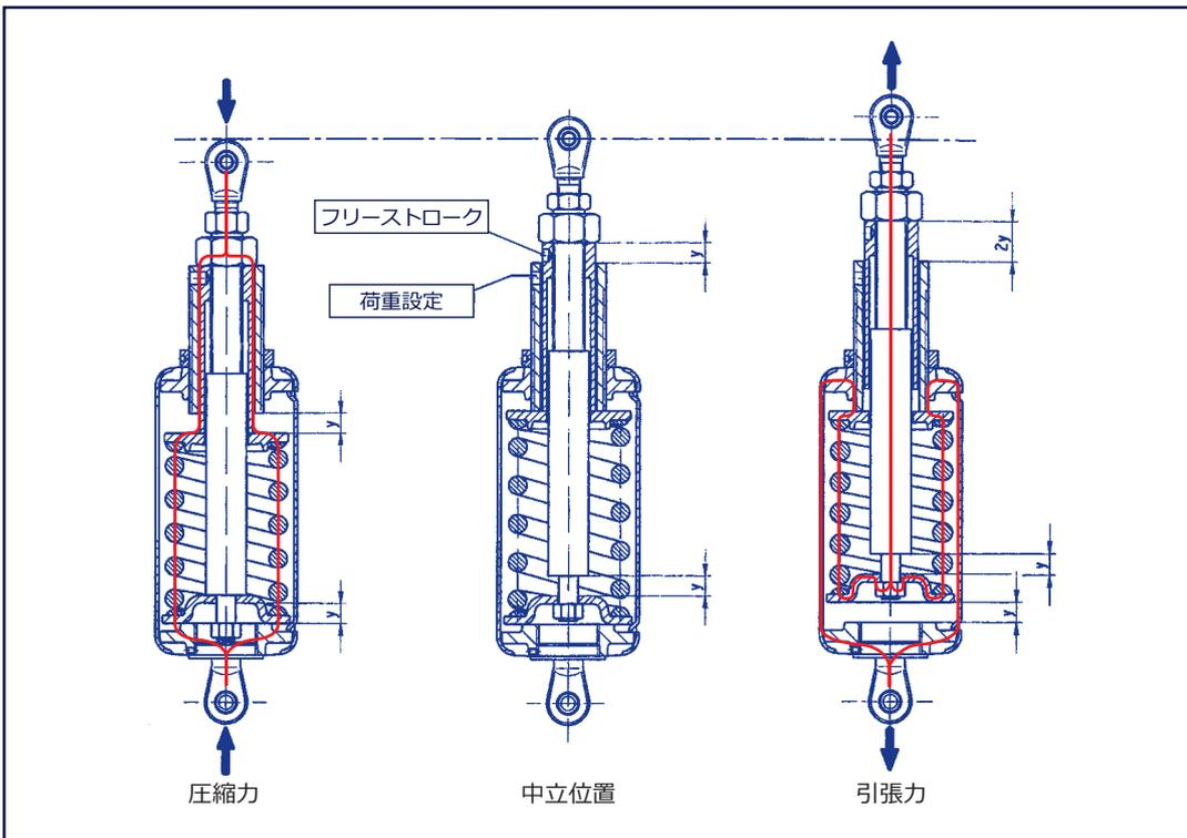
LISEGAスウェイブレースは0～25mmのフリーストロークの設定が可能です。トラベルは設定されたフリーストロークに伴い、圧縮、引張方向において減少します。
