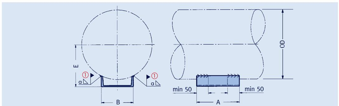
① 現地溶接 - 指定の溶接サイズ及び許容荷重では、溶接部応力は50N/mm<sup>2</sup>以下です。
