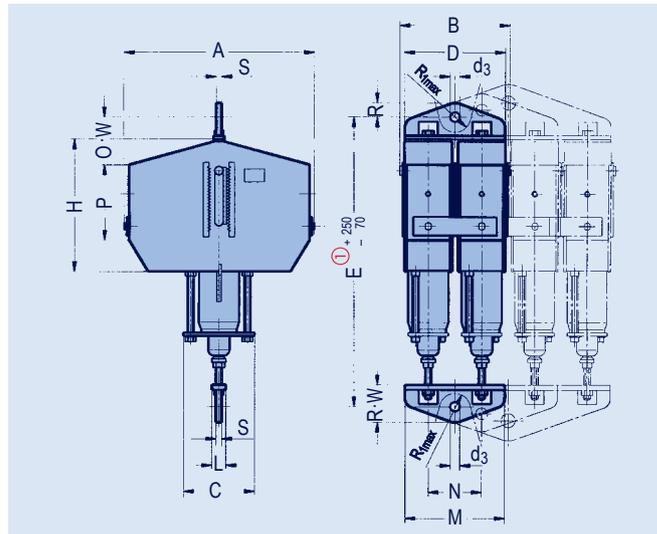
① 取付け寸法Eは上限位置での長さです。他のセット位置ではE寸法が変化します。
