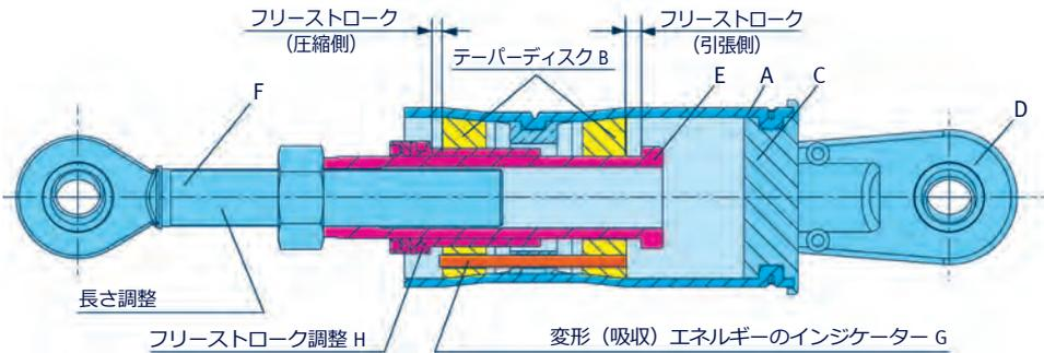
構造は、外径が部分的に細くなっているオーステナイト鋼製のケーシングチューブ(A)と、そこにはめ込まれているテーパードディスク(B)からなります。チューブは接続ラグ(D)の付いた固定ベース(C)でふさがれます。ユニット全体の力の伝達はストッパー(E)とプッシュロッド(F)を介してなされます。
