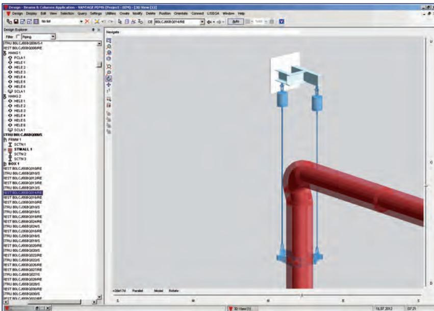
ステップ4：LICAD®のサポートを3Dモデルに統合して干渉チェックし、二次鋼材を追加
