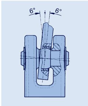
接続部の球面軸受ジョイントは溶接ブラケットタイプ 35に適合するよう設計されています。
