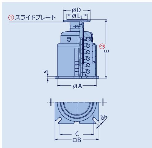
$$E \text{ [mm]} = \text{最小荷重時の } E \text{ [mm]} - \frac{\text{設定荷重 [kN]} - \text{最小荷重 [kN]}}{\text{ばね定数 [N/mm]}} \times 1000$$
