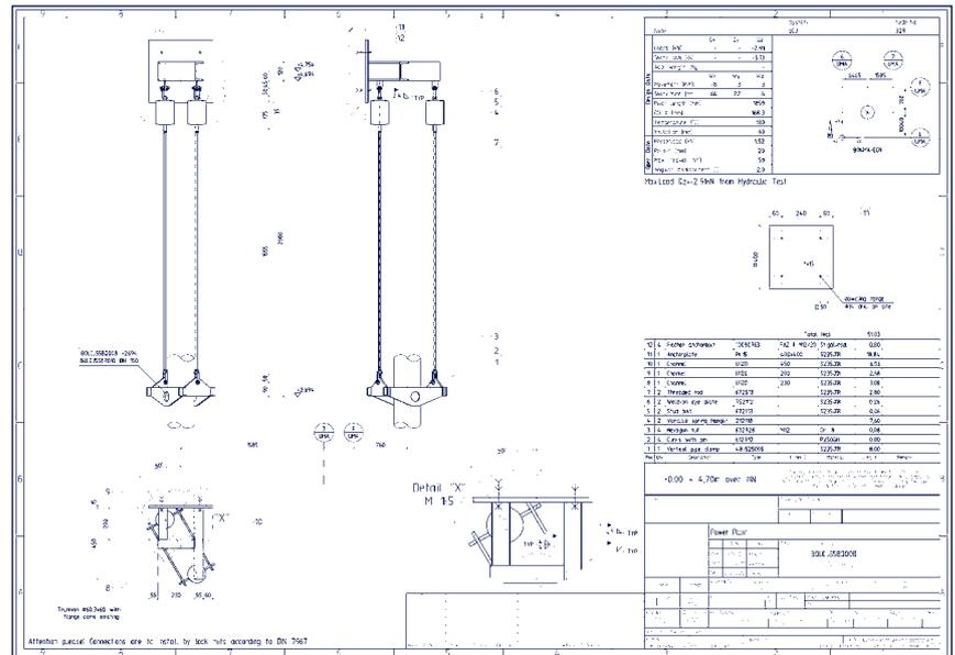
ステップ6：断面や部分詳細図を追加した詳細図面（据付用図面）の作成
