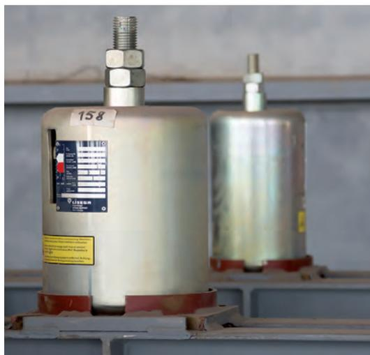
一般的な仕様として、冷間時と運転時の許容荷重差は運転時荷重に対して25%以下となっています。
