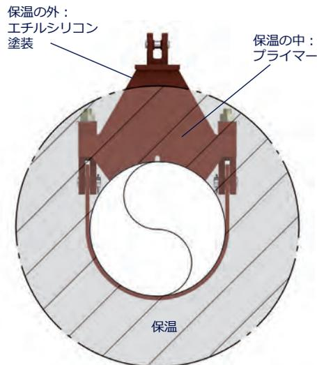
パイプクランプの塗装施工例
