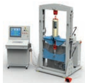
Prüfen eines Federhängers am LISEGA-120kN-Prüfstand
