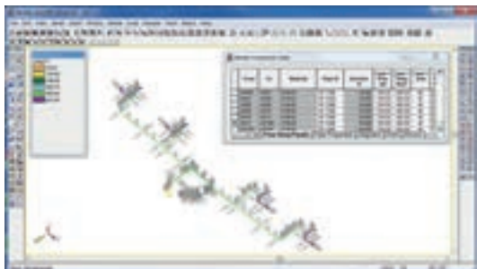
Rohrleitungssystem in AutoPIPE®
