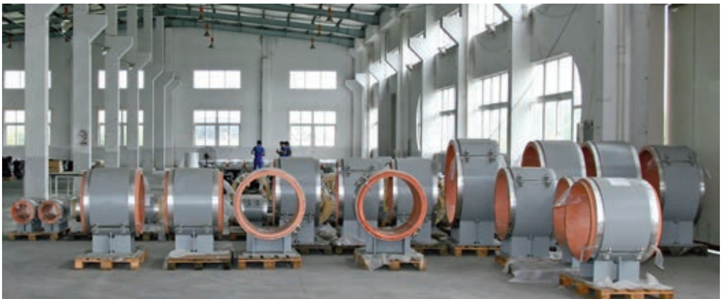
Vormontierte kälteisolierte Rohrlager
