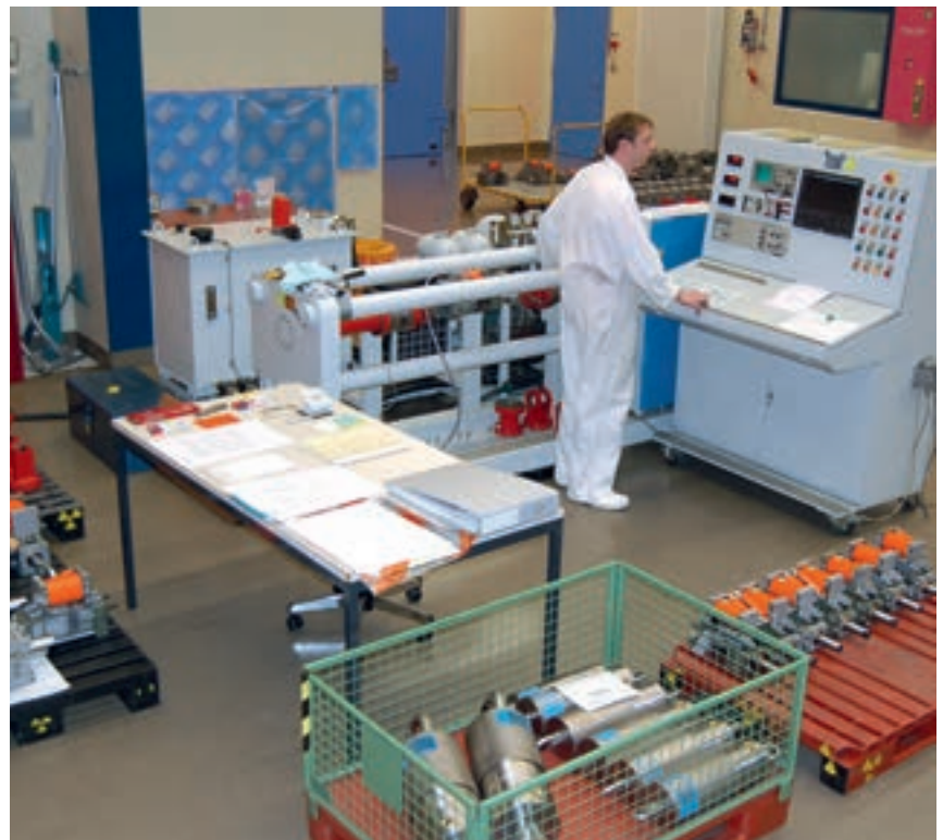
Prüfen von Stoßbremsen verschiedener Fabrikate in der Anlage mit einem mobilen LISEGA-Prüfstand
