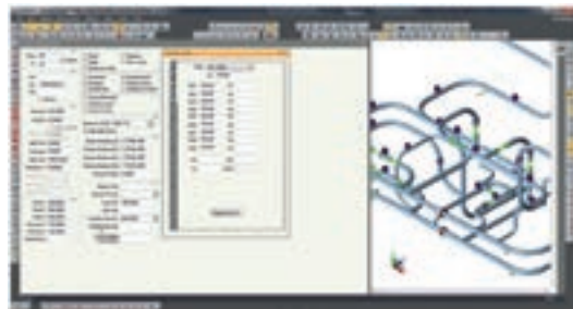
Rohrleitungsanalyse mit CAESAR II®
