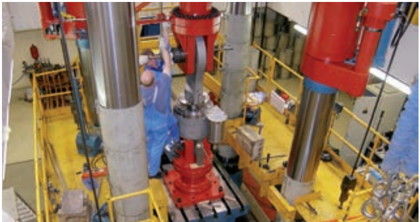
Sonderprüfung von Stoßbremsen Typ 31 Prüflast bis 8600KN
