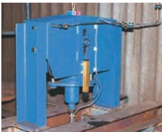
Comme paramètre de commande, en règle générale, la température de la tuyauterie à supporter est utilisée. La température est convertie électroniquement en position de déplacement correspondant. Le procédé de comparaison des valeurs réelles / théoriques permet au dispositif de contrôle d'assurer une avance progressive vers la position verticale théorique.
