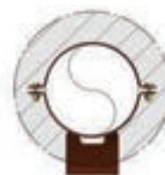
Les pièces filetées, la boulonnerie, les goussets et plaques à proximité de la tuyauterie doivent se trouver, pour une protection renforcée contre la corrosion et une température supérieure à 350°C, à l'intérieur du calorifuge.
