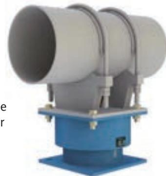
Les amortisseurs visco-élastiques LISEGA se composent d'un boîtier rempli d'un fluide visqueux qui permet les déplacements relatifs entre les embases tout en assurant un amortissement dans toutes les directions et en dissipant l'énergie (transformation en chaleur).
