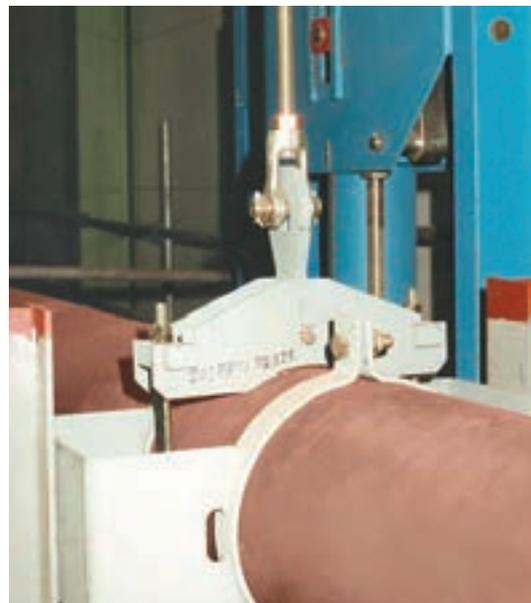
Les diamètres vont de DE 21,3 à DE 1219, pour des températures allant jusqu'à 650°C et des charges – réparties en catégories économiques – couvrant le niveau le plus élevé du domaine d'application pratique.
