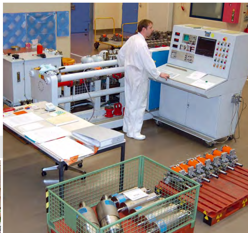
Essai des dispositifs autobloquants de différents fabricants sur site avec un banc d'essai mobile LISEGA.
