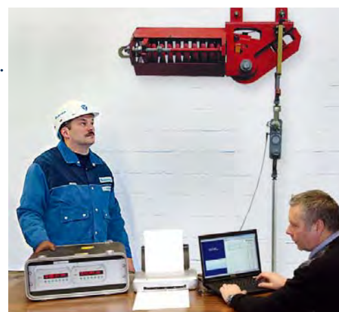
Contrôle de supports constants de tous fabricants sur site à l'aide banc d'essais mobiles
