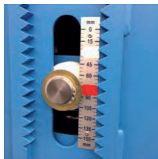
Шкала перемещения с отметкой холодного/горячего положения
