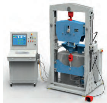
Испытание подвески постоянного усилия на испытательном стенде LISEGA на 120 кН
