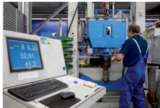
Приемочные испытания подвески постоянного усилия
