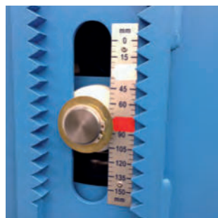
Шкала перемещения с отметкой холодного/горячего положения
