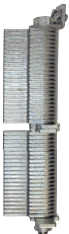
Блокирующее устройство для пружинных подвесок и пружинных опор типов 21, 25, 29 и 20 состоит из набора металлических пластин, которые могут быть повернуты в любое требуемое положение блокировки. В пружинные подвески может вставляться до 3-х блокирующих устройств.
