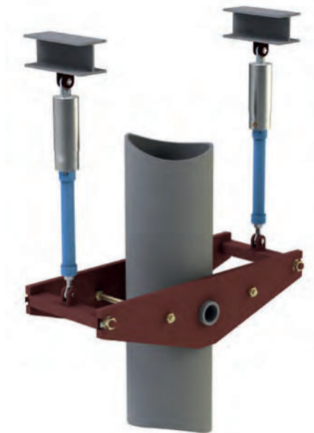
Защита вертикального участка трубопровода с помощью ударных стопоров типа 30 с монтажными удлинителями типа 33 и динамическим трубным хомутом типа 34
