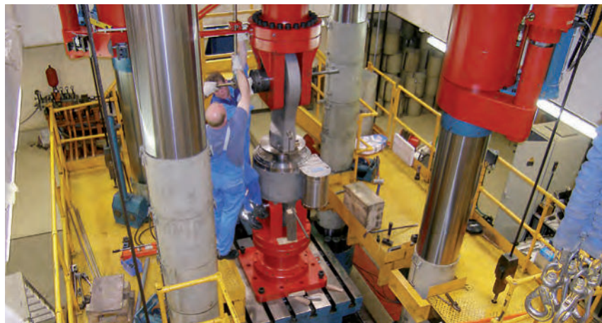
Проведение специальных испытаний ударных стопоров типа 31. Испытательная нагрузка до 8600 кН
