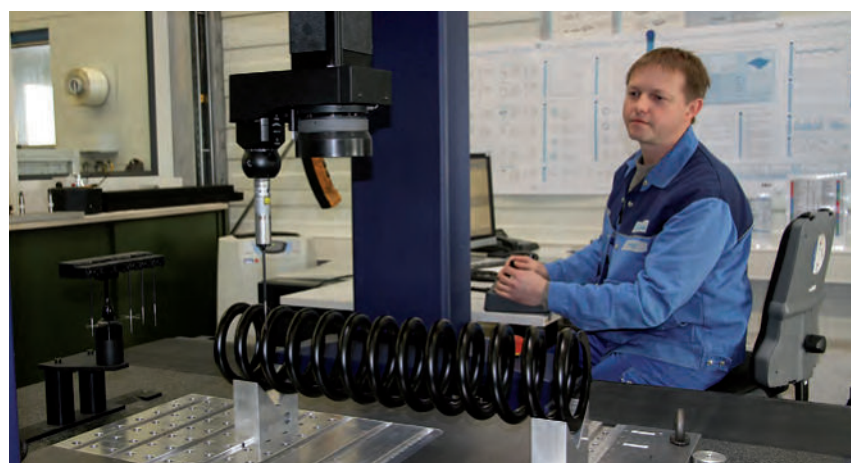
Испытание пружин на приемке материала
