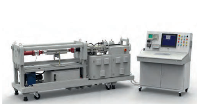
Мобильный испытательный стенд PR50 для ударных стопоров LISEGA 50 кН
