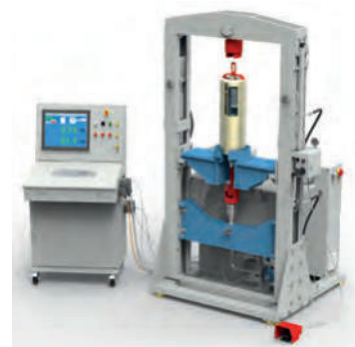
Испытание пружинной подвески на испытательном стенде на 120 кН LISEGA
