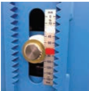
Echelle de course avec marquage au montage/en service
