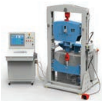
Essai d'un Support Constant sur banc LISEGA de 120kN
