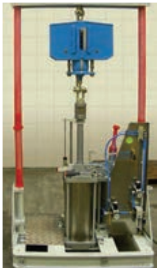
Essais de supports constants sur site à l'aide d'un banc d'essai transportable
