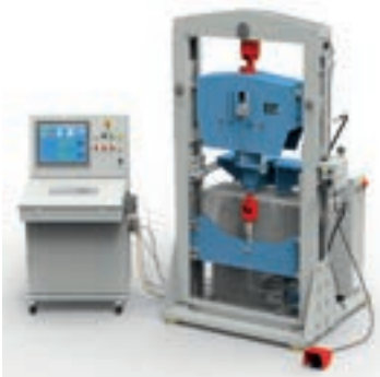
Prüfen eines Konstanthängers am LISEGA-120kN-Prüfstand
