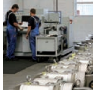
Prüffeld für Stoßbremsen im Werk Zeven, Deutschland
