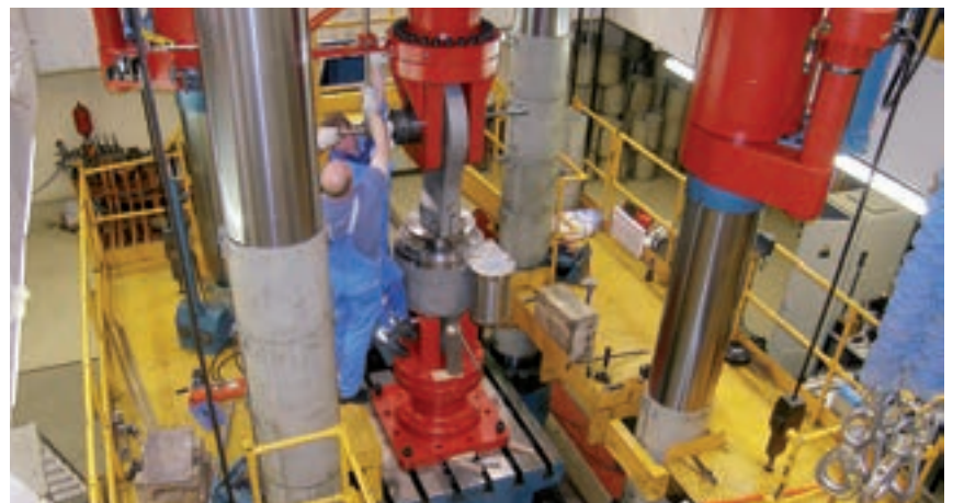
Sonderprüfung von Stoßbremsen Typ 31 Prüflast bis 8600kN
