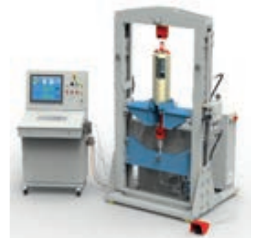
Prüfen eines Federhängers am LISEGA-120kN-Prüfstand
