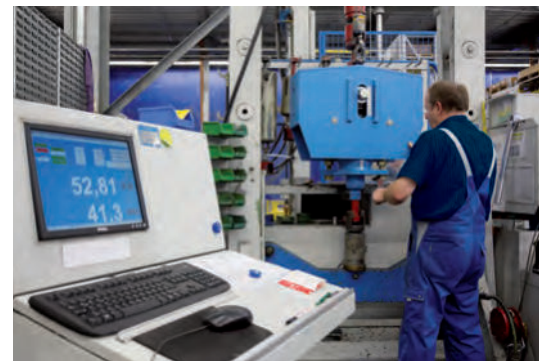
Essai de réception d'un Support Constant
