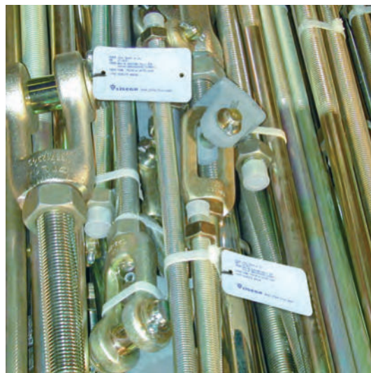
Supports pré-montés regroupés en fardeau et identifiés
