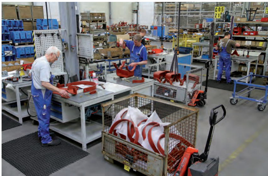
Pré-montage des chaînes de support
