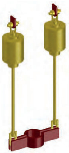
Supports standard LISEGA dans SmartPlant® 3D
