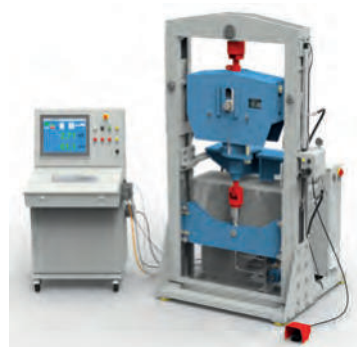
Essai d'un Support Constant sur banc LISEGA de 120kN
