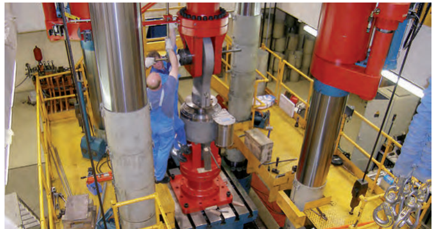
Essais spécifiques de DAB Type 31 sous charge de 8600kN
