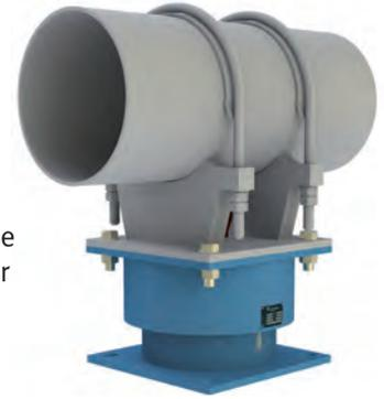
Les amortisseurs visco-élastiques LISEGA se composent d'un boîtier rempli d'un fluide visco-élastique qui permet les déplacements relatifs entre les embases tout en assurant un amortissement dans toutes les directions et en dissipant l'énergie (transformation en chaleur).
