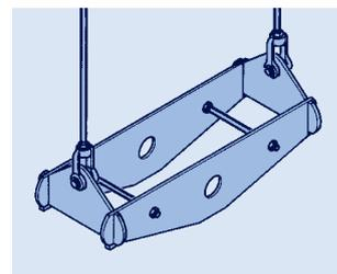
Collier vertical Type 48 avec pièces de raccordement
