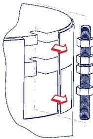
Les clés de blocages sont extraites des encoches du boîtier
