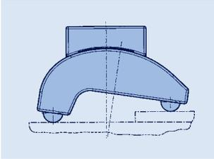
Les parties des clames durcies sont munies d'un rond fileté qui s'enfonce sous la pression dans la surface d'appui. **La finition rugueuse des clames forme une surface auto-adaptable donnant une sécurité complémentaire en cas de mouvement des éléments à fixer.**
