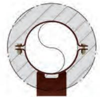
Les pièces filetées, la boulonnerie, les goussets et plaques à proximité de la tuyauterie doivent se trouver, pour une protection renforcée contre la corrosion et une température supérieure à 350°C, à l'intérieur du calorifuge.
