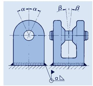
Angle d'inclinaison maximal
