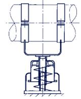
Support variable à charge posée télescopique Type 29 .. 2.
