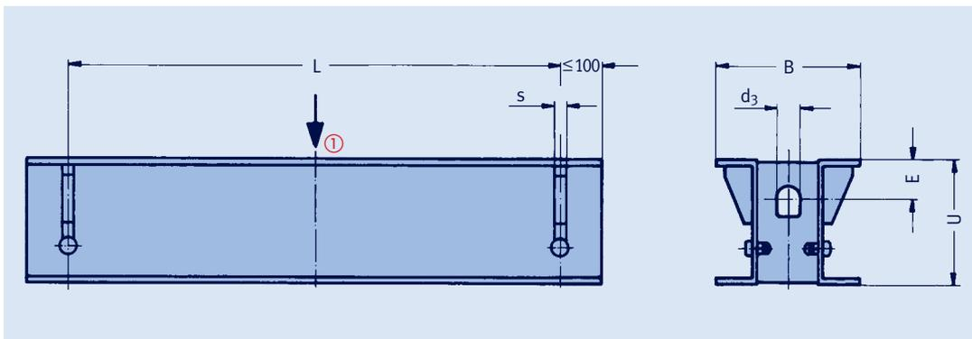
① Pour la charge admissible au point de raccordement central se référer au groupe de charge de la traverse (3e ou 3e et 4e chiffre de la désignation).
