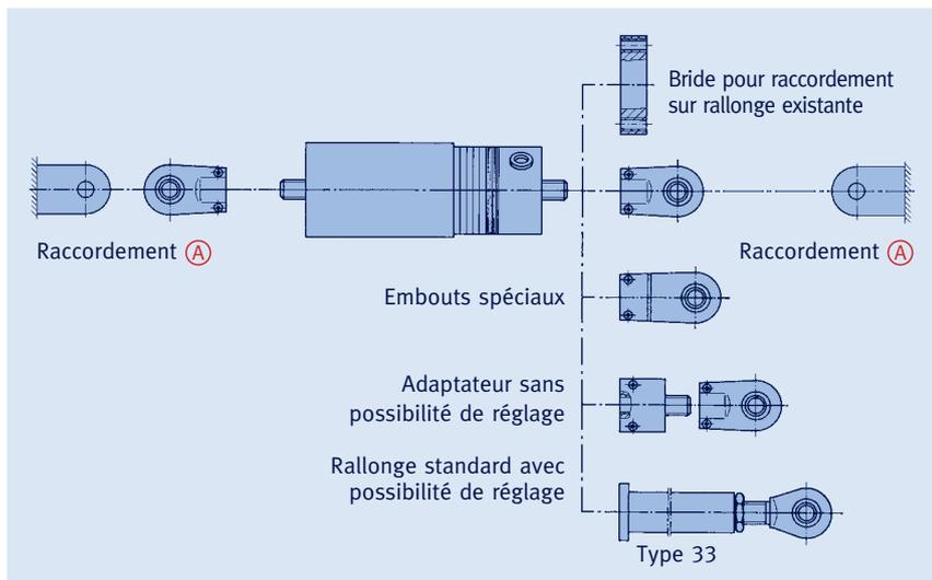
(A) Possibilités de raccordement: voir le diamètre des axes des chapes à souder Type 35 et des colliers dynamiques du groupe de produits 3.
