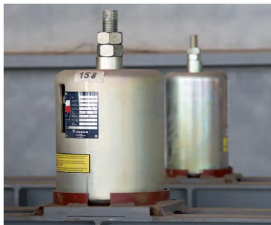
**En général la variation admissible entre la charge au montage (charge de blocage) et la charge en service est limitée à 25% de la charge en service.**
