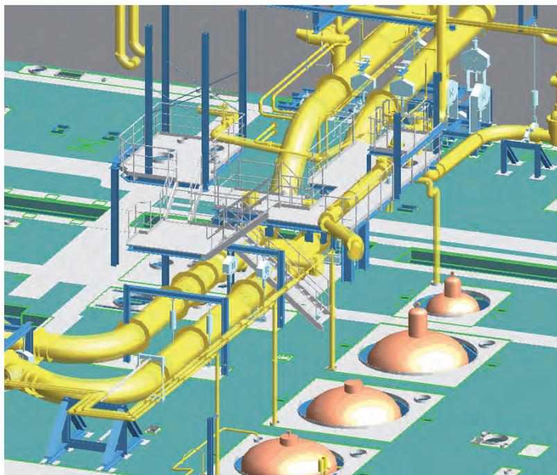
Au travers de la fonction exportation, les supports peuvent être insérés dans la maquette 3D.
