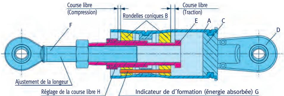
L'élément consiste en une enveloppe extérieure en acier austénitique (A) et une enveloppe intérieure dans laquelle ont été enchâssés des disques en bronze (B). L'enveloppe extérieure est obturée par un fond (C) sur lequel la pièce de raccordement a été fixée. Les efforts sont transférés au travers de tout l'élément par les butées (E) et la tige (F).
