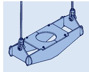
Collier vertical Type 46 avec pièces de raccordement
