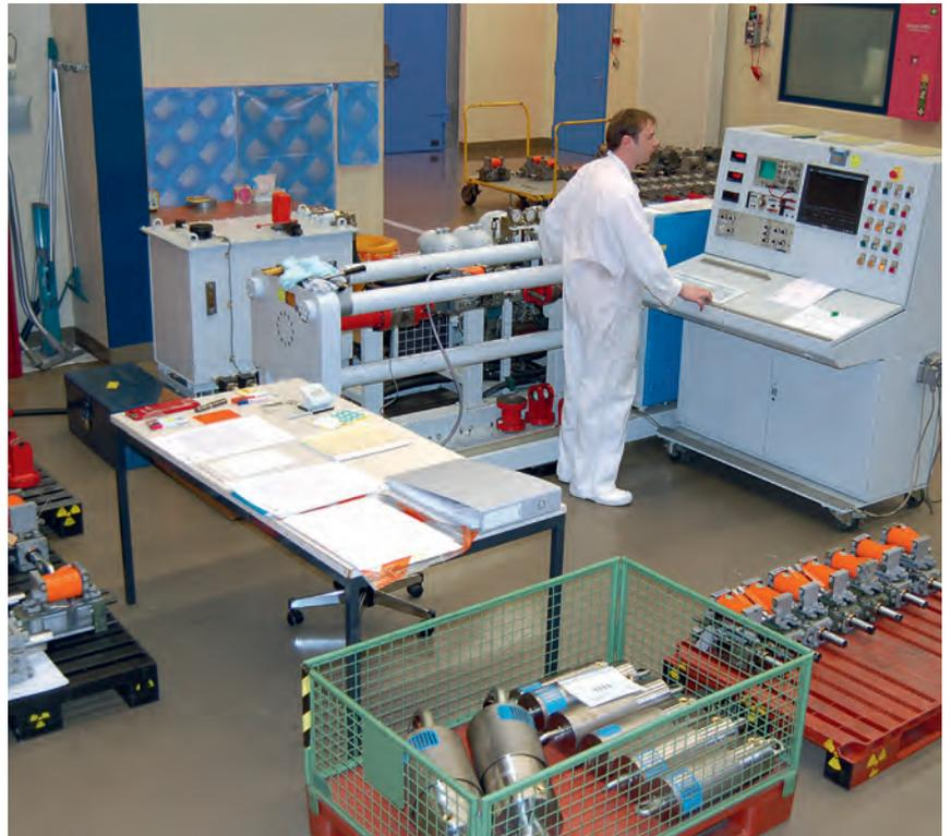
Contrôle de DAB des différents fournisseurs sur site avec un BANC D'ESSAI LISEGA transportable
