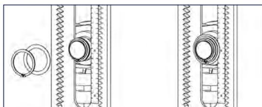
② Remise en place du circlip extérieur
