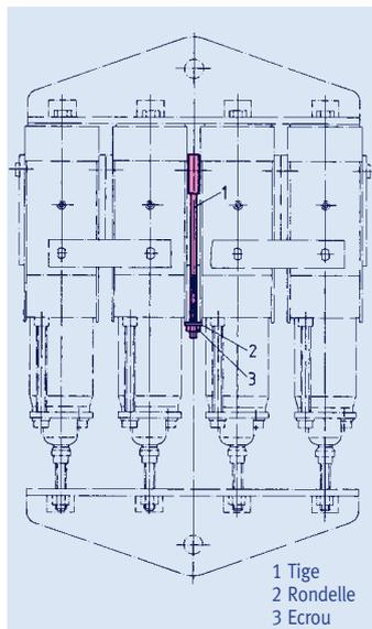
Dispositif de sécurité pour le transport Types 12 82 .. à 14 96 ..
