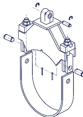
La position du collier est à vérifier une nouvelle fois et à ajuster. Ensuite positionner le collier puis serrer les écrous et les bloquer. Pour se prémunir d'un desserrage des écrous les freins d'écrous sont à replier.
