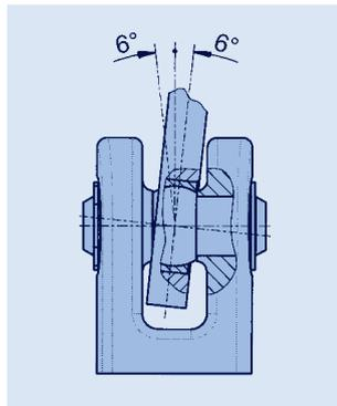
Les embouts à rotule pour le raccordement sont adaptés aux chapes à souder Type 35.
