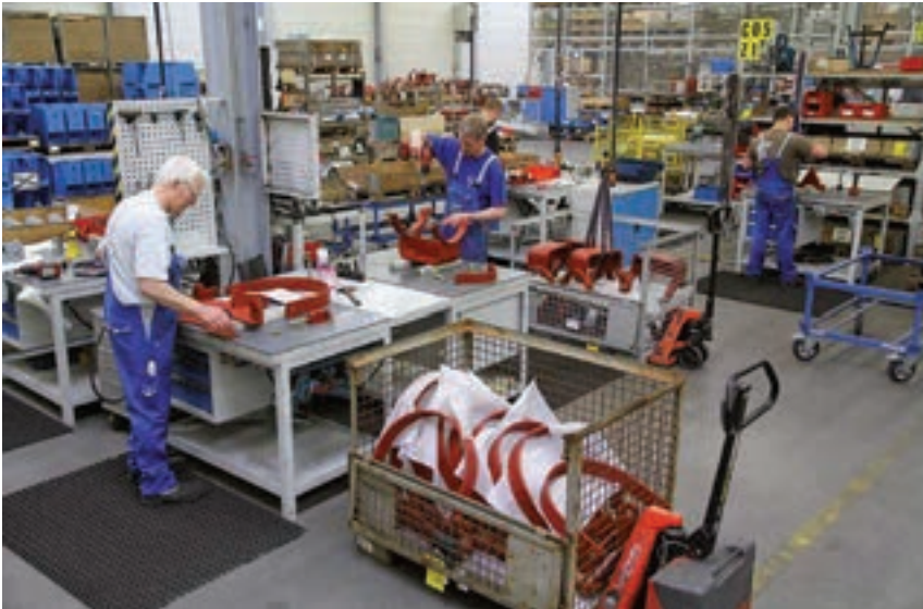
Pré-montage des chaînes de support
