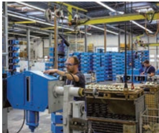
Montage des supports constants
