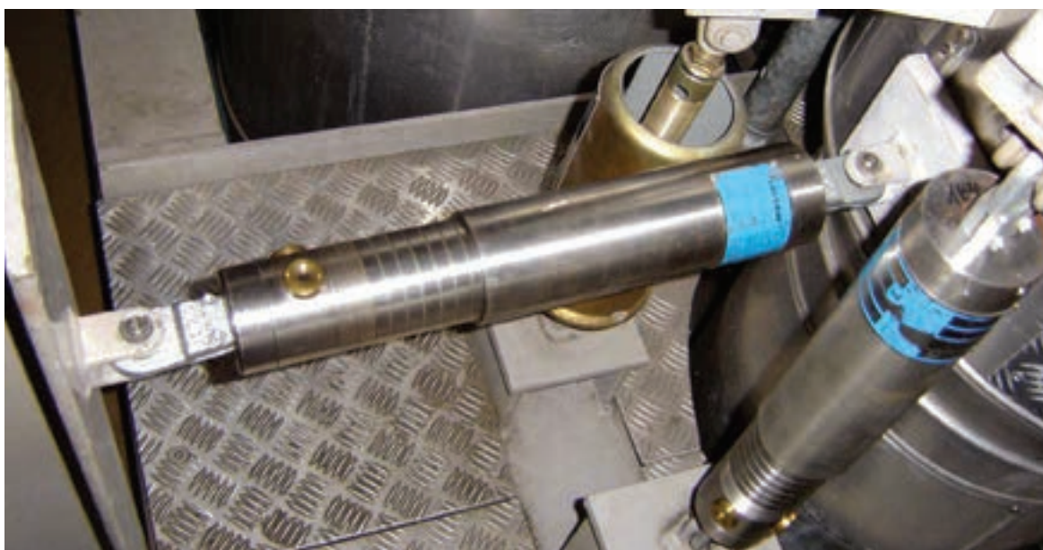
Installation d'un DAB Type 30
