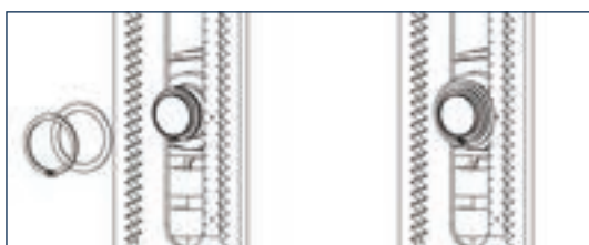
② Remise en place du circlip extérieur
