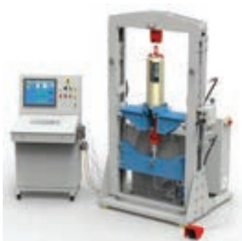
Essai d'un Support Variable sur banc LISEGA de 120kN
