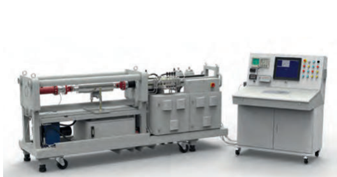
Mobiler LISEGA-50kN-Stoßbremsen- prüfstand PR50
