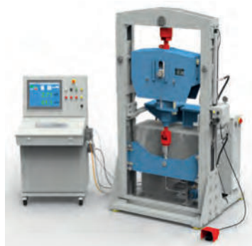
Prüfen eines Konstanthängers am LISEGA-120kN-Prüfstand
