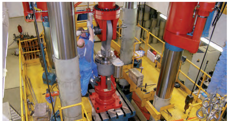
Sonderprüfung von Stoßbremsen Typ 31 Prüflast bis 8600kN
