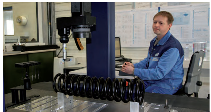
Wareneingangsprüfung der Federn
