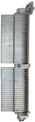
Die Blockierung besteht bei Federhängern und Federstützen der Typen 21, 25, 29 und 20 aus Blechlamellen, die auf jede gewünschte Lasteneinstellung einstellbar sind. Es werden bis zu 3 Blockierungen an einem Federhänger eingesetzt.
