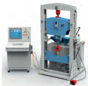
Prüfen eines Konstanthängers am LISEGA-120kN-Prüfstand
