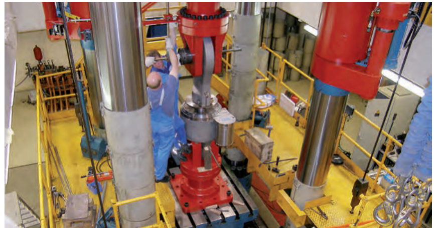
Sonderprüfung von Stoßbremsen Typ 31 Prüflast bis 8600kN
