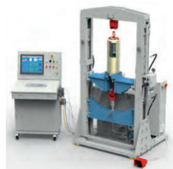
Prüfen eines Federhängers am LISEGA-120kN-Prüfstand
