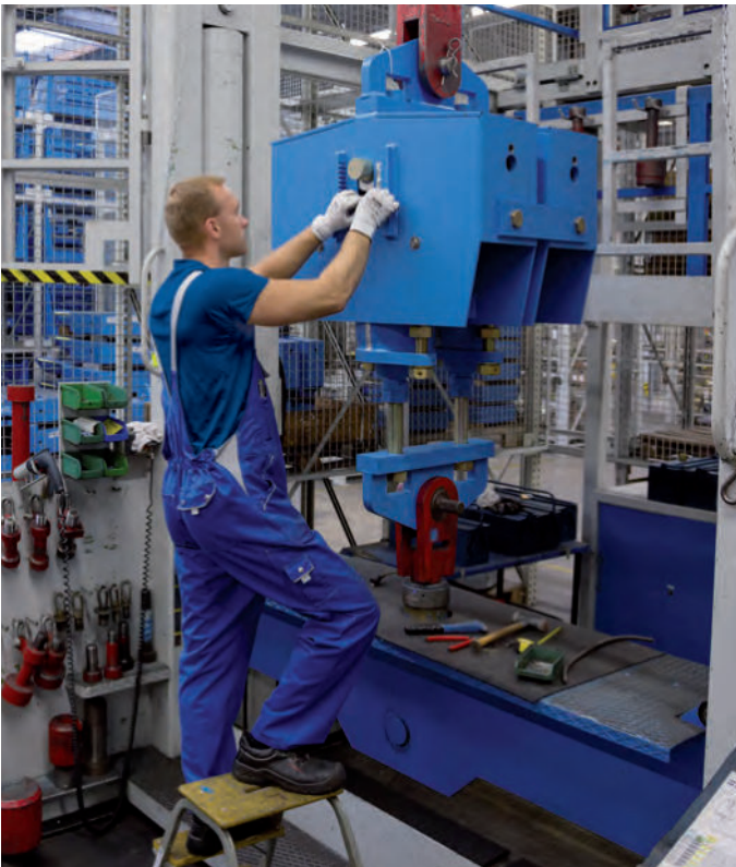
Einstellen, prüfen und blockieren eines Konstanthängers Typ 12 am 500kN Prüfstand
