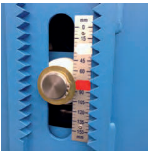
Wegskala mit Kalt- / Warmmarkierungen
