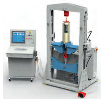
Prüfen eines Federhängers am LISEGA-120kN-Prüfstand
