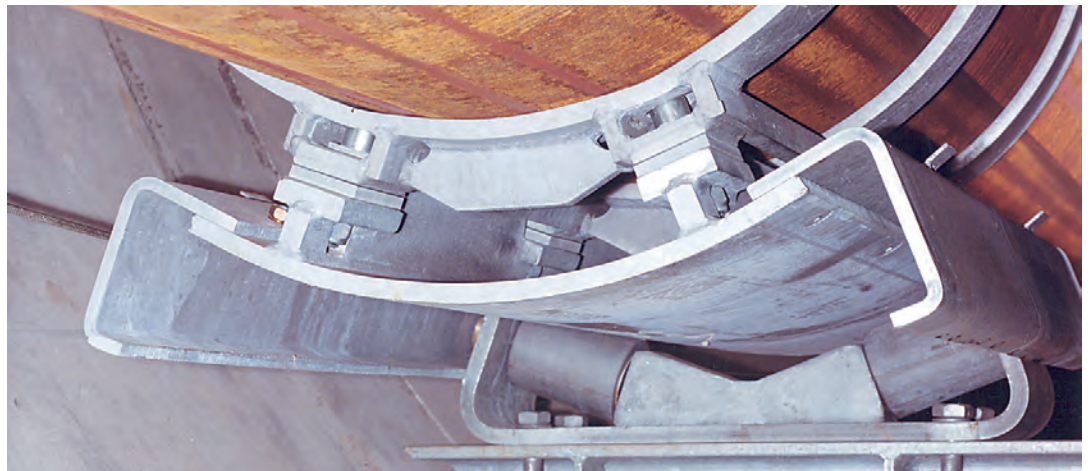
Sonder-Rohrsattel Typ 54 mit Doppelzylinderrollenlager Typ 53 und Abhebesicherungen Typ 55
