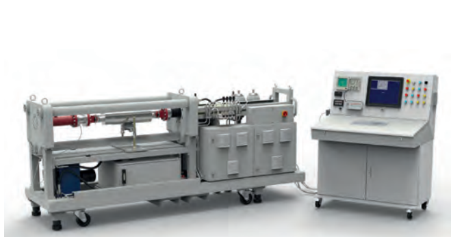
Mobiler LISEGA-50kN-Stoßbremsenprüfstand PR50
