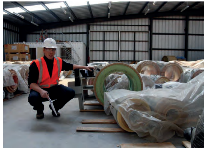
Endkontrolle von kälteisolierten Rohrlagern
