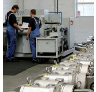
Prüffeld für Stoßbremsen im Werk Zeven, Deutschland
