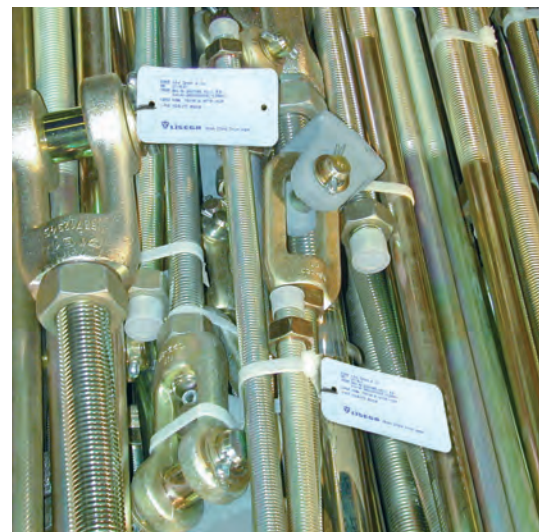
Lastketten, vormontiert, gebündelt und markiert
