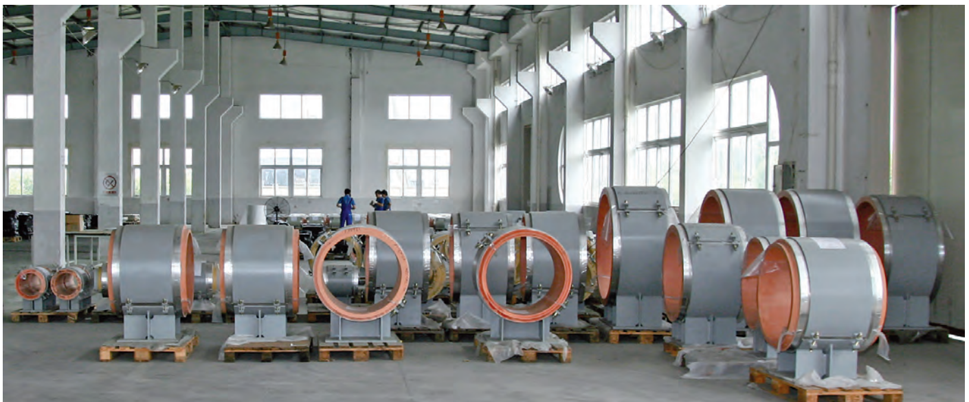
Vormontierte kälteisolierte Rohrlager
