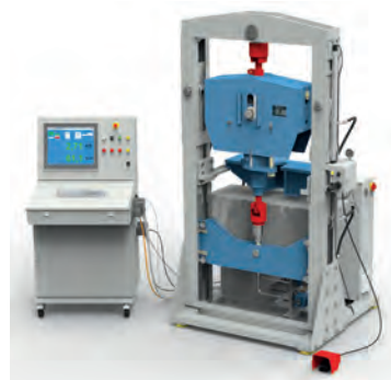
Prüfen eines Konstanthängers am LISEGA-120kN-Prüfstand
