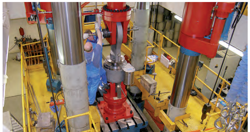
Sonderprüfung von Stoßbremsen Typ 31 Prüflast bis 8600kN
