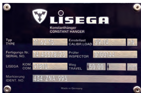
Typenschild mit eingepprägten Betriebsdaten
