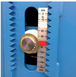
Wegskala mit Kalt- / Warmmarkierungen
