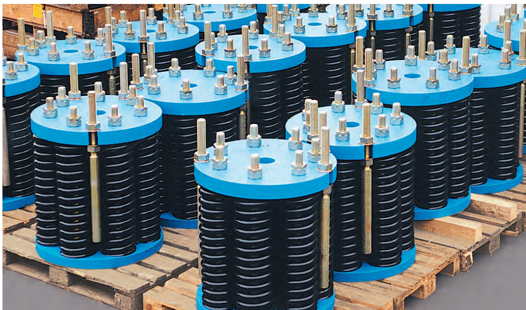
Federpakete als Sonderausführung für den Einsatz bei einem Kraftwerkskessel
