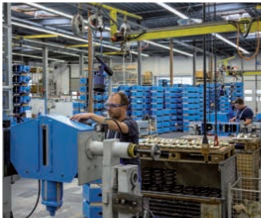
Окончательная сборка подвески постоянного усилия
