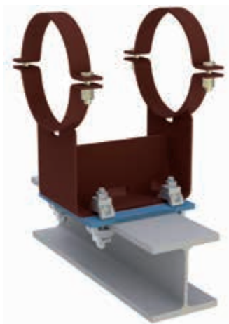
Пример использования: Присоединение хомутовой опоры к стальной балке
