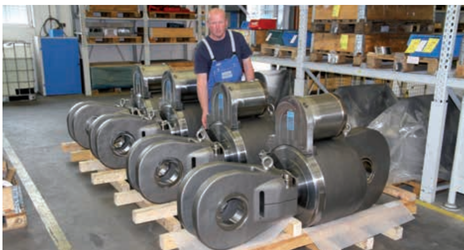
Окончательная проверка ударных стопоров типа 31
