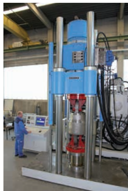
Испытательный стенд на 2500 кН в компании LISEGA
