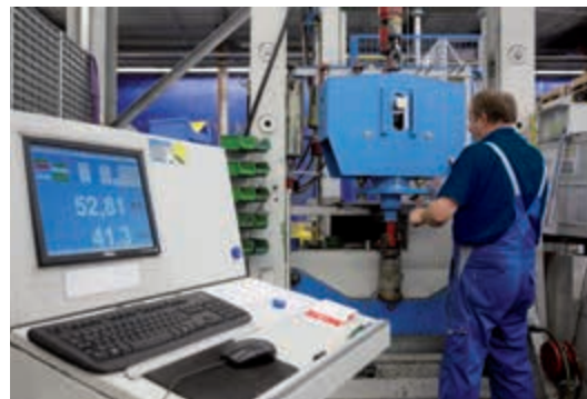
Приемочные испытания подвески постоянного усилия
