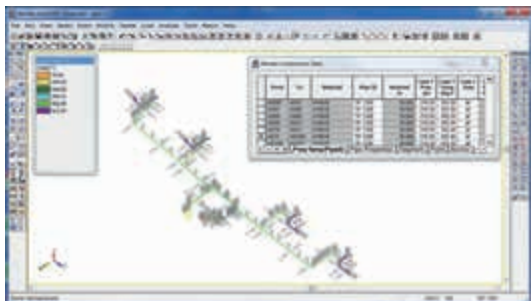
Трубопроводы в AutoPIPE®
