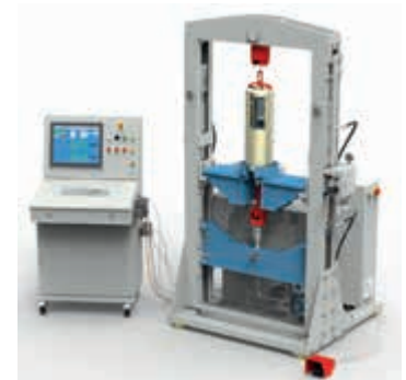
Испытание пружинной подвески на испытательном стенде на 120 кН LISEGA
