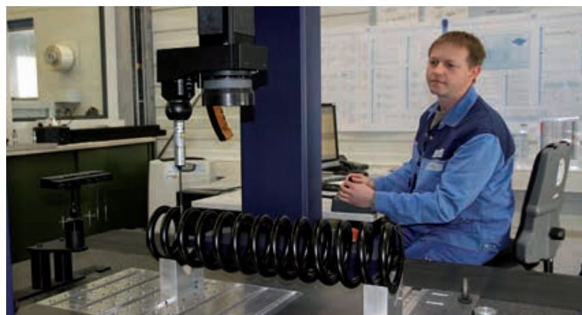
Испытание пружин на приемке материала
