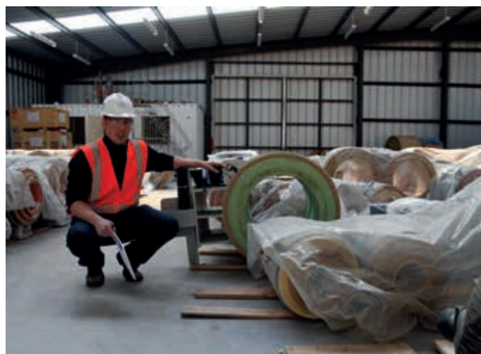
Окончательная проверка низкотемпературных изолированных опор
