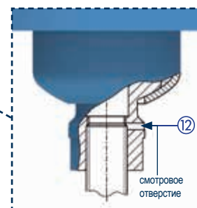
Мин. глубина ввинчивания соединительного стержня в воспринимающую нагрузку трубу
