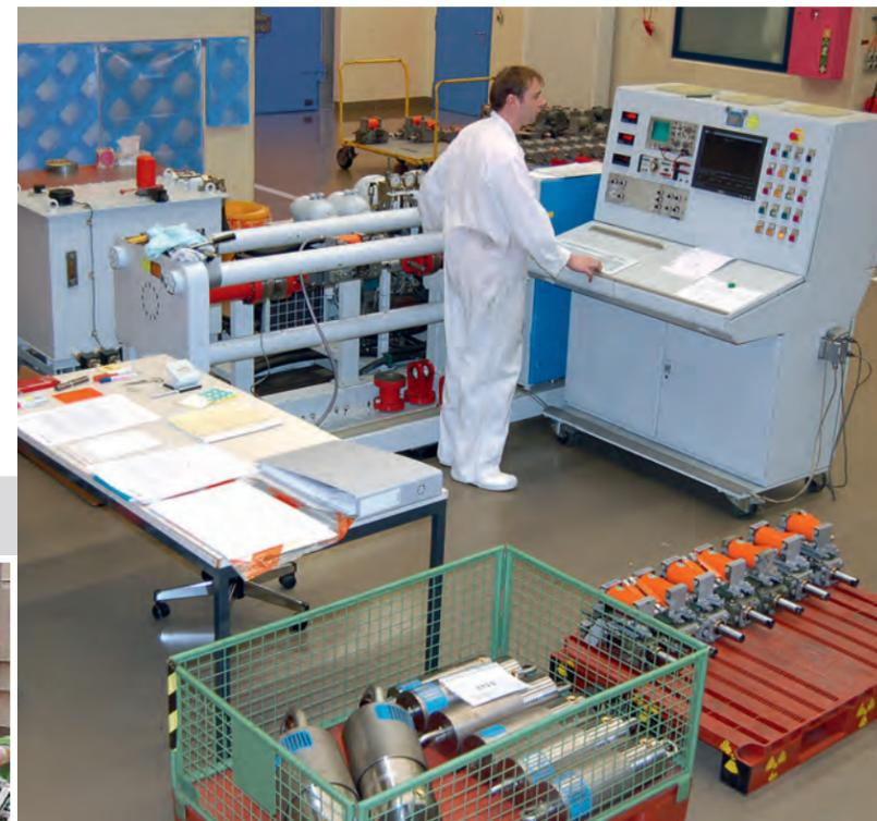
Wiederholungsprüfungen von Stoßbremsen verschiedener Fabrikate in der Anlage mit einem mobilen LISEGA Prüfstand
