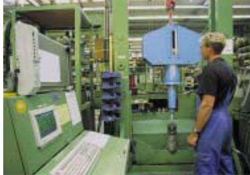
Приемочные испытания подвесок постоянного усилия
