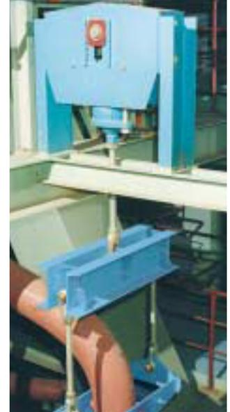
Для функциональных испытаний, все заводы оборудованы испытательными стендами квазистатического действия с нагрузкой до 1000 кН. Испытательные стенды инспектируются с регулярными интервалами времени независимым органом.
