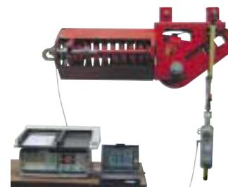
Испытания подвесок постоянного усилия на месте с использованием передвижного испытательного стенда
