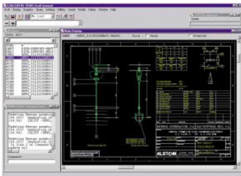
Двухмерные чертеж опоры, созданные непосредственно из трехмерной модели
