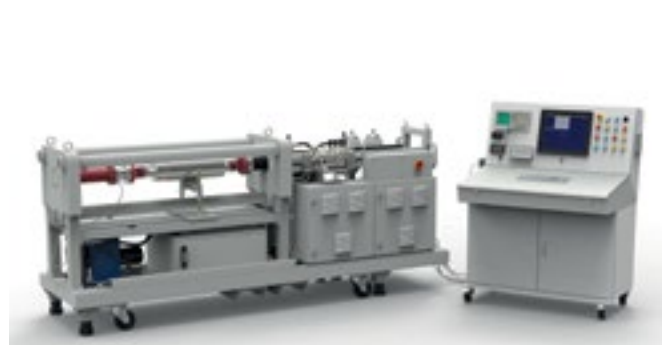
Mobiler LISEGA-50kN-Stoßbremsenprüfstand PR50
