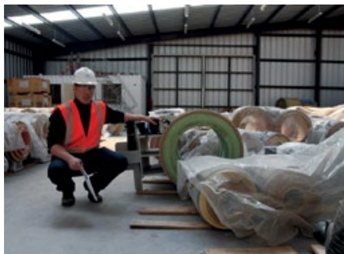
Endkontrolle von kälteisolierten Rohrlagern
