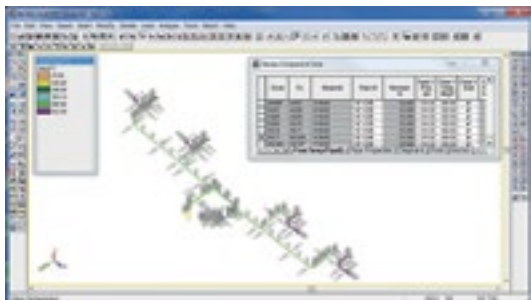
Rohrleitungssystem in AutoPipe®
