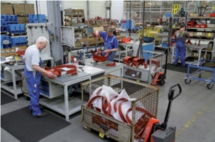
Vormontage von Lastketten
