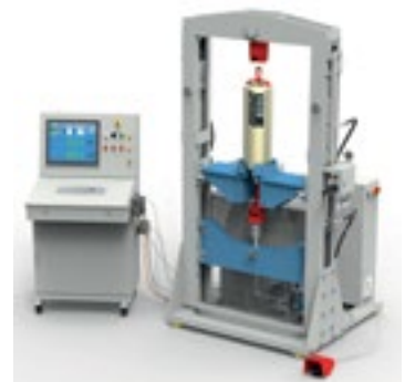
Prüfen eines Federhängers am LISEGA-120kN-Prüfstand
