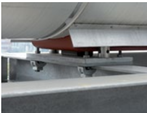
Rohrlager Typ 49 auf Gleitplatte, mit Klemmverbindung zum Stahlbau
