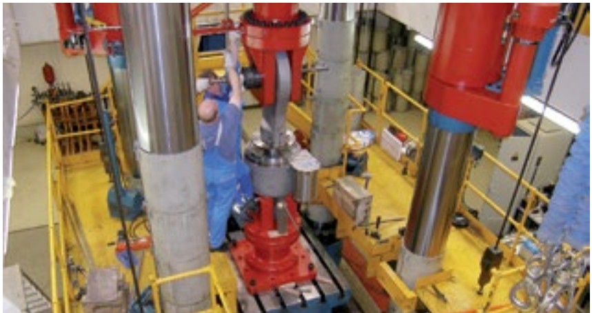
Sonderprüfung von Stoßbremsen Typ 31 Prüflast bis 8600kN
