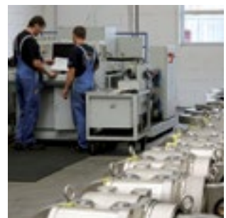
Prüffeld für Stoßbremsen im Werk Zeven, Deutschland
