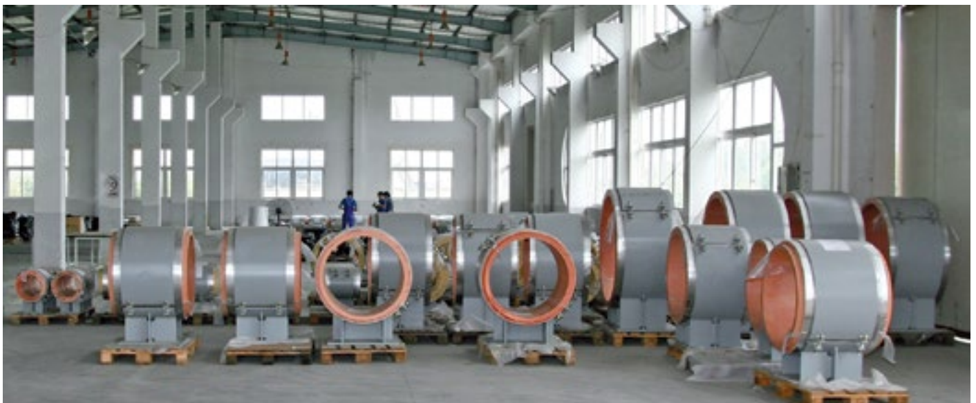
Vormontierte kälteisolierte Rohrlager
