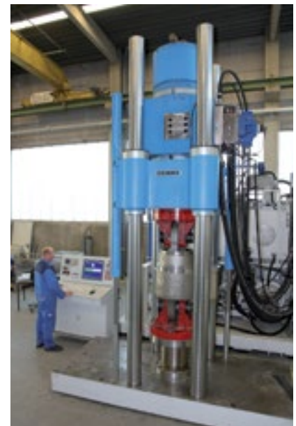
2500kN Prüfstand bei LISEGA
