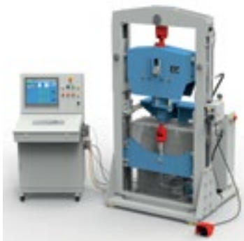
Prüfen eines Konstanthängers am LISEGA-120kN-Prüfstand
