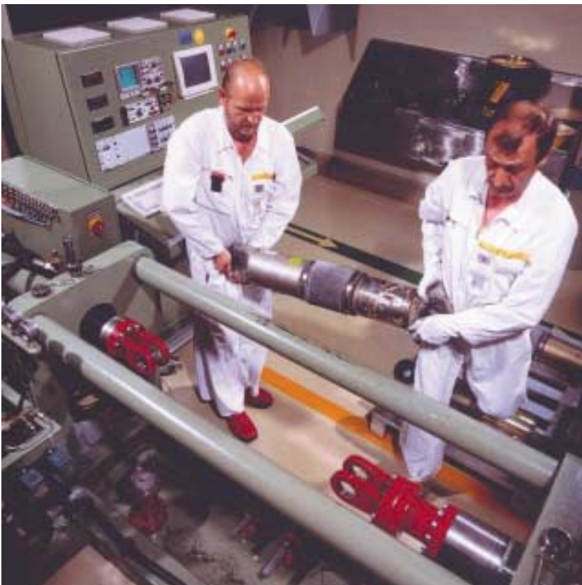
Prüfen von PSA Stoßbremsen in der Anlage mit einem mobilen LISEGA-Prüfstand.
