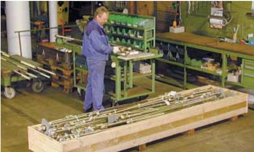
Vormontage von Lastketten
